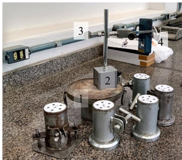
Figura 5 – Equipamento para medição da variação dimensional. Legenda: base metálica (1), base magnética (2), garra (3) e trena à laser (4).
