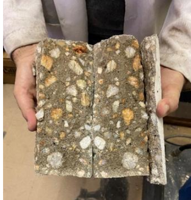
Figura 2 - Corpo de prova com ruptura nos agregados.
