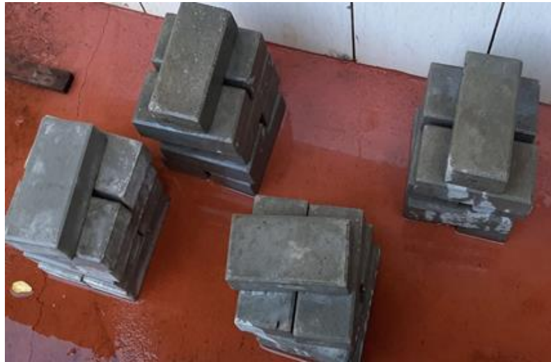
Figura 3 - Blocos de pavimentação desformados.
