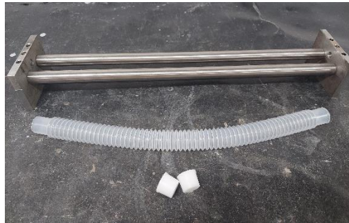
Figura 3 – Bancada do dilatômetro juntamente com um molde de tubo corrugado com duas tampas de extremidade.
