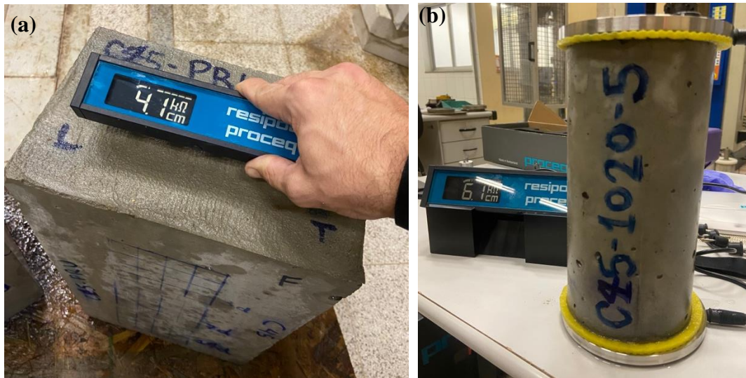
Figura 2 - Ensaio de resistividade elétrica superficial aparente no prisma (a) e volumétrica nos corpos de prova cilíndricos (b).
