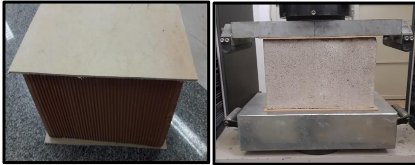
Figura 4 - Ensaio de resistência à compressão com capeamento de MDF nos blocos cerâmico (à esquerda) e de Concreto (à direita).
