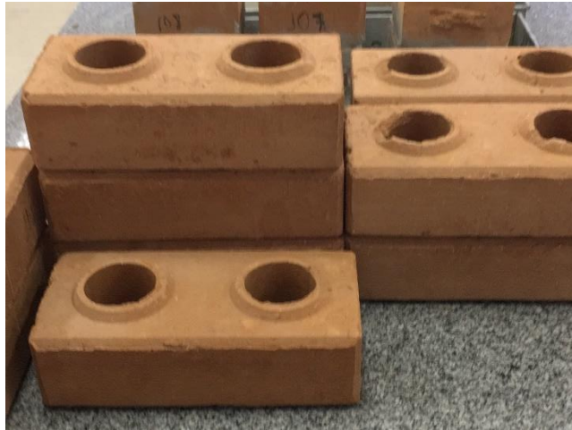
Figura 2 - Tijolo solo-cimento com dimensões de 250x125x70 mm (comprimento, largura, altura).
