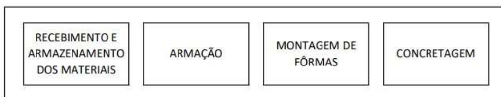
Figura 2 – Etapas da estrutura.
