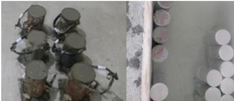
Figura XI – Corpos de Prova Moldados/Tanque de Cura. Fonte: Própria (2020).
