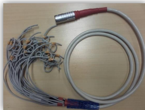
Figura 5.11 - Cabo multieletrodo confeccionado para automatização da coleta de dados de resistividade elétrica do solo.
