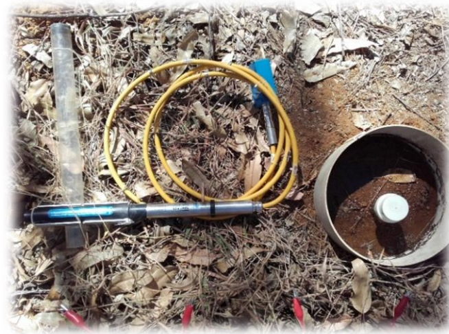
Figura 5.9 - Experimento em campo. Vista em planta i) da sonda TDR utilizada para monitoramento da \theta , ii) do tubo de acesso da sonda TDR, com área de umedecimento delimitada por um tubo PVC de 0,2 m de diâmetro; e iii) de quatro eletrodos centrais utilizados no ERI, indicados pelos terminais vermelhos na borda inferior na imagem.
