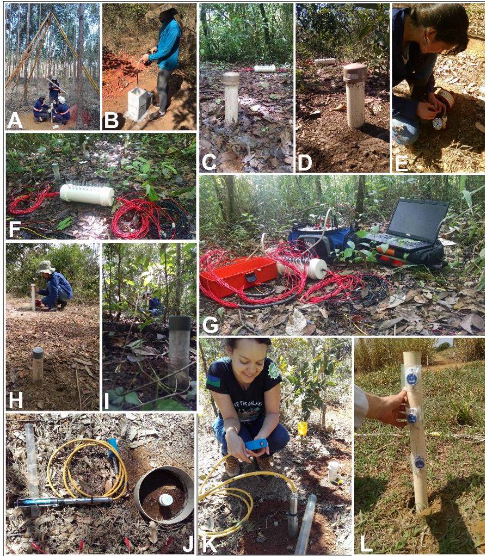
Figura 5.6 - Representação esquemática do monitoramento hidrológico subterrâneo realizado na FAL-UnB. A-D) Poços de monitoramento do nível da água subterrânea. E) Manutenção dos tensiômetros. F-G) Linhas de ERT instaladas. H-K) Tubos de acesso padrão e PVC e sonda TDR utilizada no monitoramento da \theta . L) Sensores de temperatura do solo.
