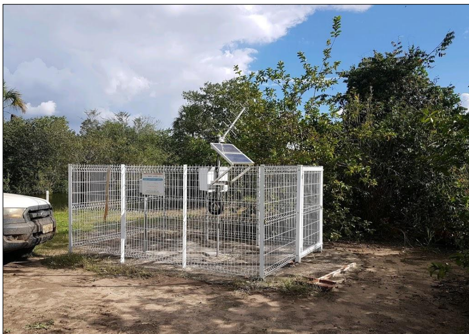
Foto 15 - Estação hidrológica de código INEMA GR-FR-23 com sistema de telemetria.
