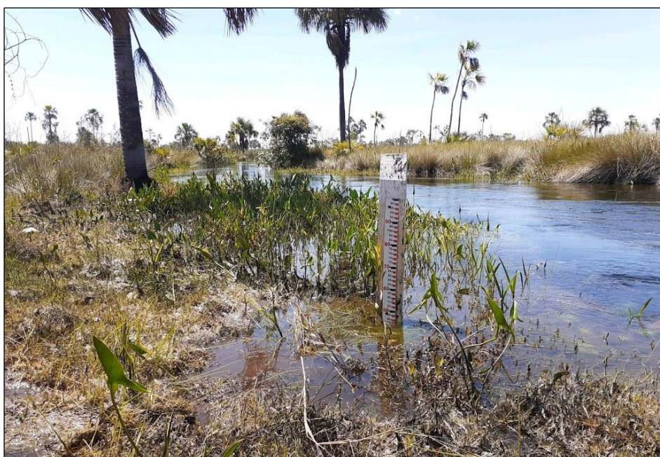
Foto 14 - Régua de monitoramento fluviométrico da estação ANA-4657030.
