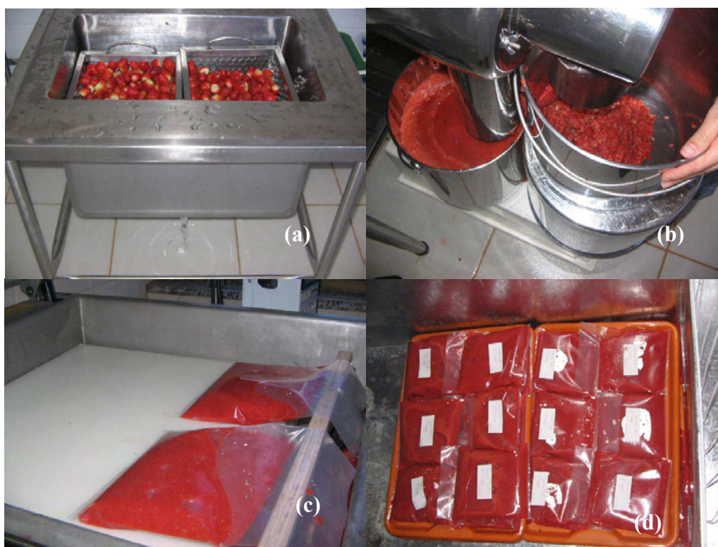
Figura 3 Processamento de polpa congelada: (a) sanitização; (b) despoldagem; (c) selamento da embalagem e (d) congelamento
