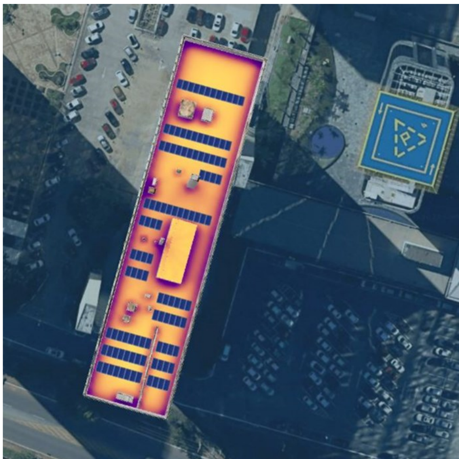
FIGURA 30 SOMBREAMENTO DE PONTOS DE GERAÇÃO DE FV FONTE Autoria própria
