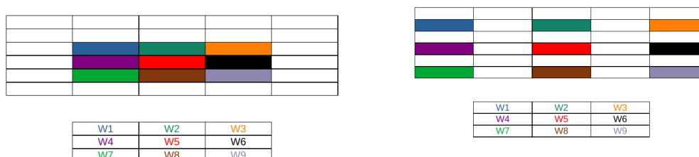
Figura 16 – À esquerda: convolução tradicional, onde a multiplicação da matriz de pesos com a entrada está marcada com cores distintas. À direita: convolução atrous , onde há uma dilatação dos pesos e se nota que, com a mesma quantidade de parâmetros, obtém-se um campo de visão maior que a convolução tradicional.
