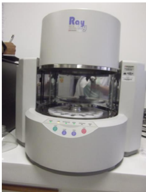
Figura 2: Espectrômetro de Fluorescência de Raios X por Energia Dispersiva da Marca Shimadzu, modelo EDX-720, aberto para receber as amostras
