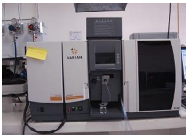
Figura 3: Espectrofotômetro de Absorção Atômica utilizado para as análises de potássio nos exsudatos das sementes de Dalbergia miscolobium Benth.
