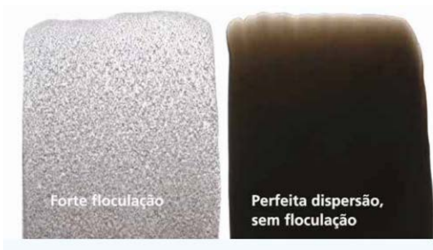
Figura 8. Dispersões de pigmento preto de partícula de carbono fina em microscopia de luz transmitida. 24
