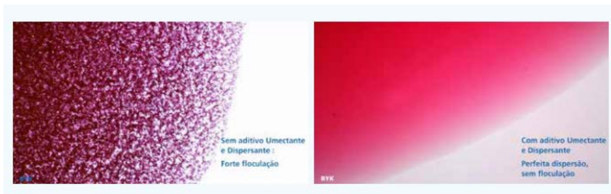
Figura 7. Processo de floculação e defloculação em gota de tinta de pigmento vermelho orgânico ao microscópio de luz transmitida. 24
