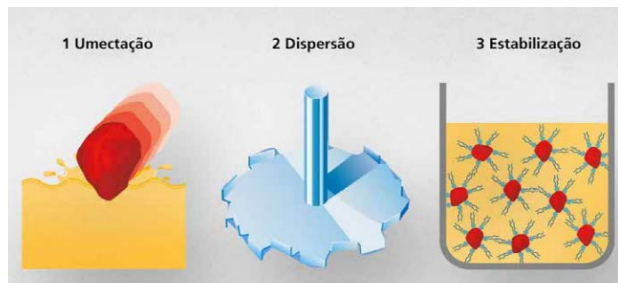
Figura 4. Processo de dispersão do pigmento na resina e solvente. 24
