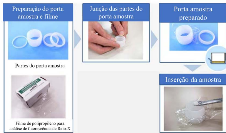
Figura 114. Esquema do empacotamento da amostra 95
