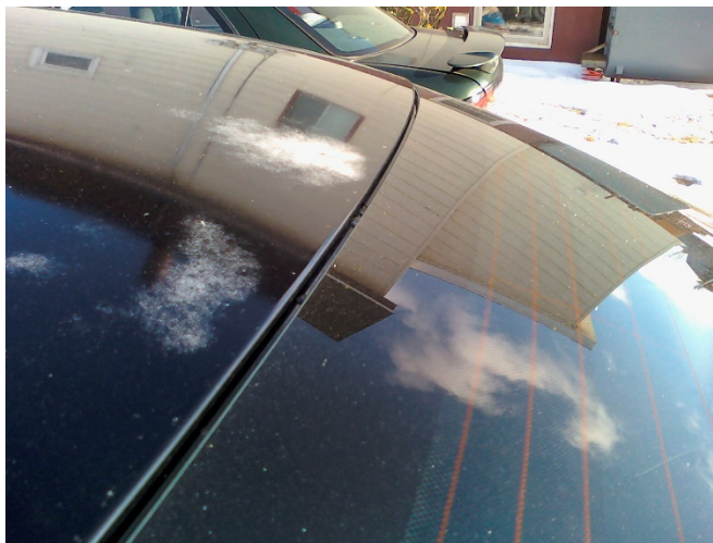
Figura 3. Exemplo de farelação ou gizamento em pinturas automotivas. 20
