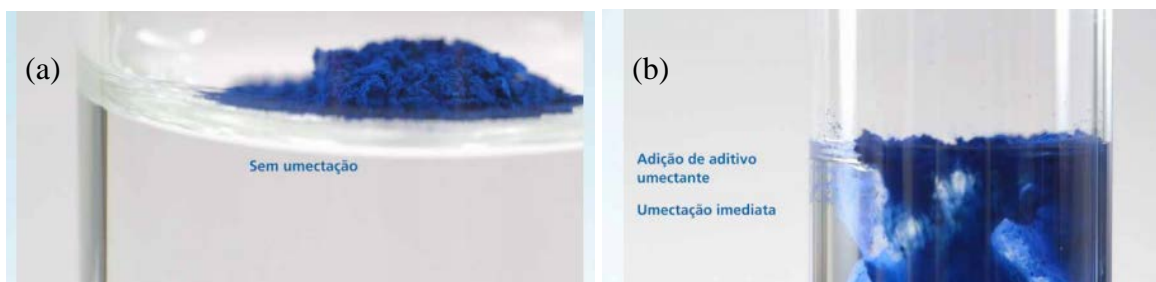
Figura 5. Processo de desaglomeração de pigmentos sólidos: (a) sem aditivo umectante e (b) com aditivo umectante. 24
