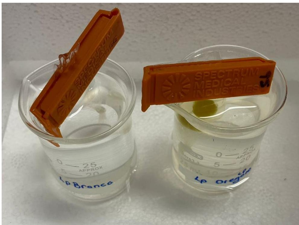
**Figura V. 9** – Hidrogéis dentro de membranas de diálise de 12 a 14 kDa, sendo a da esquerda com hidrogel contendo LpV e a da direita contendo LpC.sec.et de orégano.
