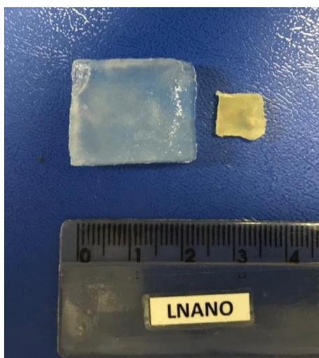
**Figura V.5** – Secção de hidrogel de agarose (3%) e carboximetilcelulose (2,5%) submetida ao teste de intumescimento em água (esquerda) quando comparada a secção de mesma área inicial submetida ao teste do ressecamento. Imagem obtida após 72 h de avaliação.
