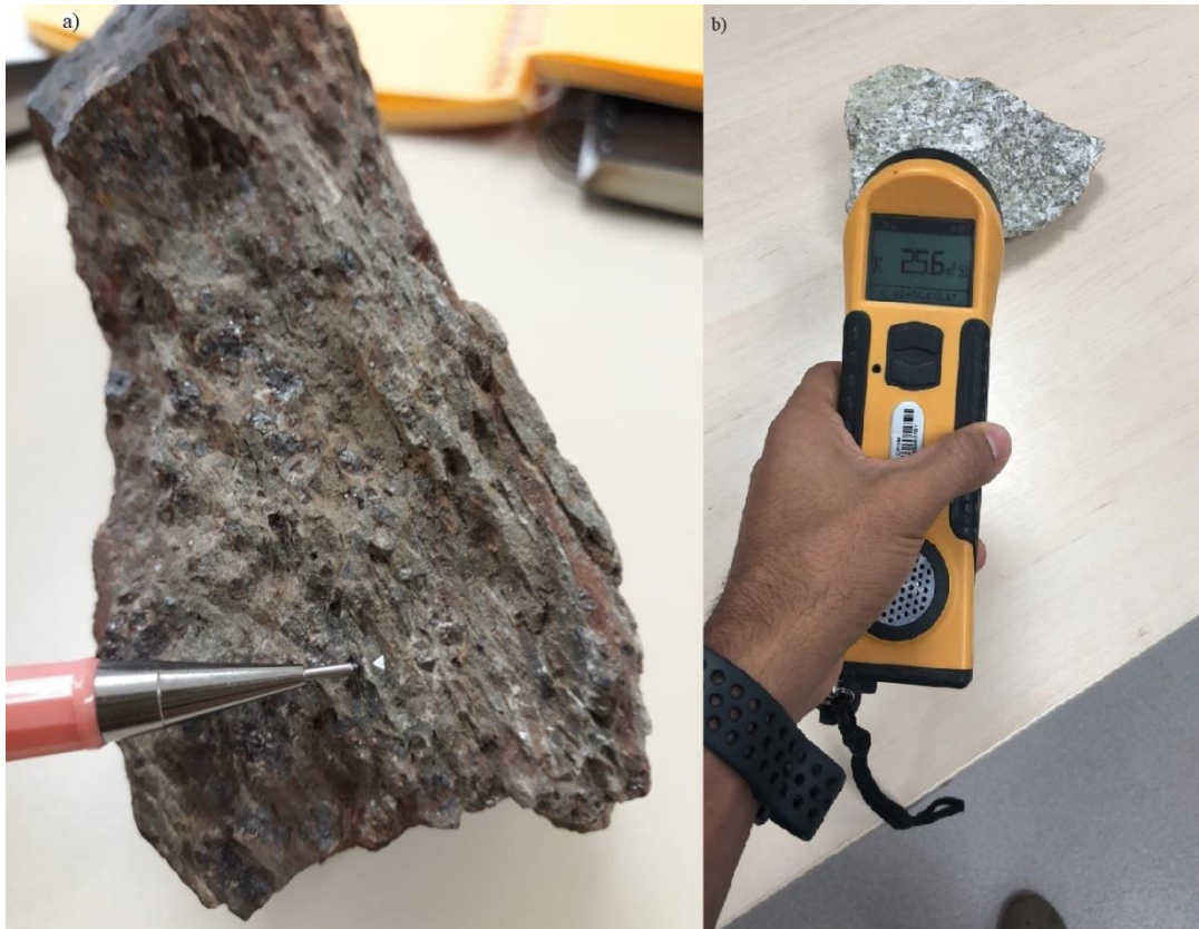
Figura 4.17- a) Amostra do greisen “preto” da Faixa Placha com magnetitas. b) Susceptibilímetro KT-10.
