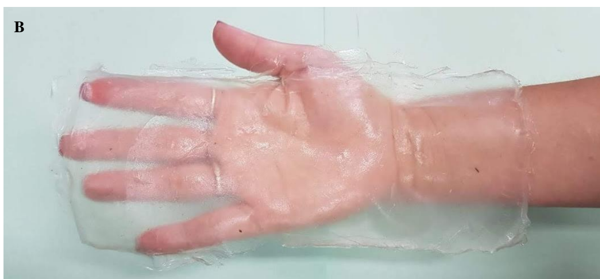
Figura 37. Filme de Biogel purificado extraído por via úmida moldados via casting . Em A, sem plastificante e B com glicerina. Gramatura de 0,0167 g/cm 2
