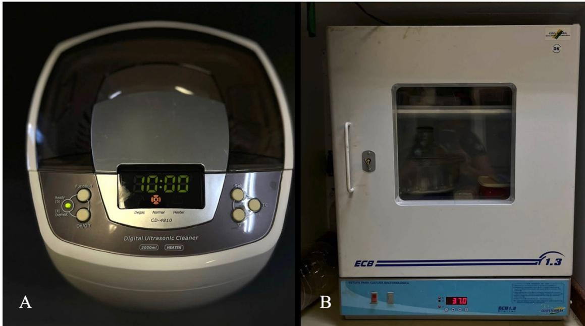
Figura 10 A) Cuba Ultrassonica utilizada para limpeza das amostras por 10 minutos após polimento (T0), após T1 e após T2. B) Estufa utilizada para armazenar as amostras ao longo de toda a pesquisa.
