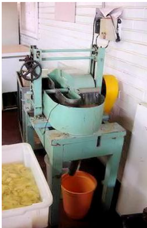
Figura 45. Para tanto pode-se usar uma refinadora tipo holandesa como acima, ou também um moinho de bolas, ou um pilão, ou martelos de madeira.
