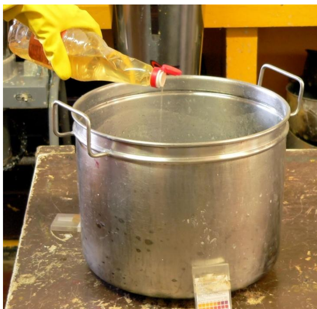
Figura 41. Quando não desejar mais utilizar o licor do cozimento faz-se necessário neutralizá-lo antes de descartá-lo. Uma das formas é acrescentar um ácido fraco, tipo ácido acético (vinagre) até que neutralize o álcali do cozimento.
