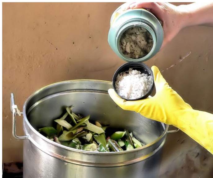
Figura 37. Acrescenta-se um álcali para a extração da celulose. Neste exemplo acrescenta-se Soda Cáustica, NaOH, na proporção de 250 g para 10 L de água. Pode-se também usar Carbonato de Sódio ( \text{Na}_2\text{CO}_3 ) ou Cinza Vegetal (decoada) entre outros álcalis.
