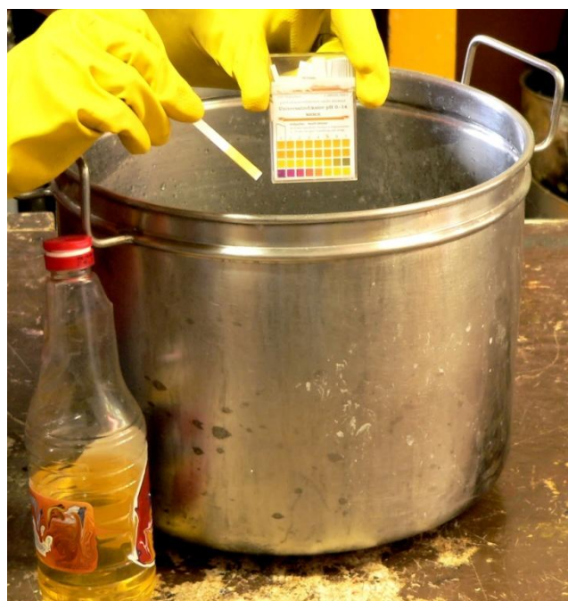
Figura 42. Com o auxílio de uma fita medidora de pH verifica-se se a solução já está neutralizada. O ideal é que o pH esteja entre 5 e 9 para que a solução possa ser descartada.
