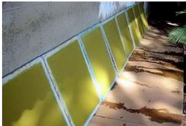
Figura 62. Pode-se secar os papéis direto nas telas. Para isso basta que haja tantas telas quantas folhas desejar formar por dia.
