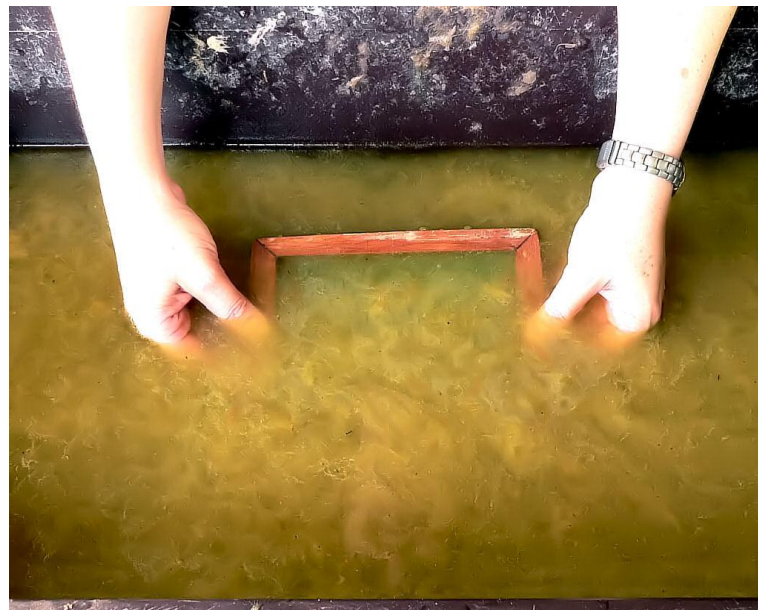
Figura 52. Introduza a tela inclinada na cuba, e faça movimentos horizontais para que as fibras se entrelacem
