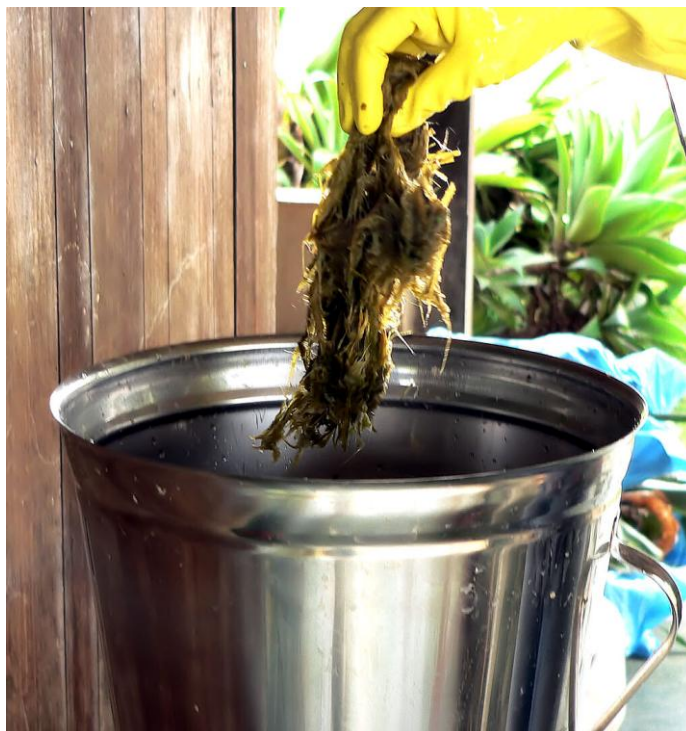
Figura 47. Depois de refinada a fibra vai ser desagregada e homogeneizada em um liquidificador.
