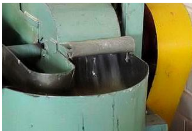
Figura 46. Um dos objetivos do refino é dar maior resistência mecânica ao papel.
