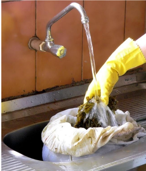
Figura 43. A fibra cozida deve ser lavada em água corrente, acondicionada no coador de nylon, para a retirada de toda a soda residual. Nesta etapa pode-se também dar um banho na fibra com uma solução de água e um ácido fraco, tipo ácido acético (vinagre), para neutralizar o pH da mesma.
