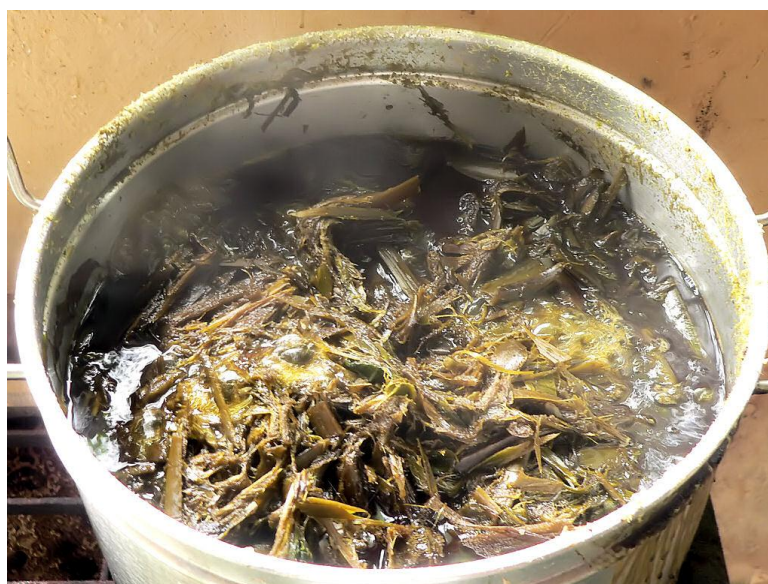
Figura 38. Deixe cozinhar até as fibras começarem a se soltar. Em alguns processos o tempo de cozimento pode ser entre 02 a 04 horas. Se necessário acrescente mais água. A função do cozimento com a adição de um álcali é retirar a lignina entre outros extrativos vegetais presentes nas fibras que não são necessários na fabricação do papel.
