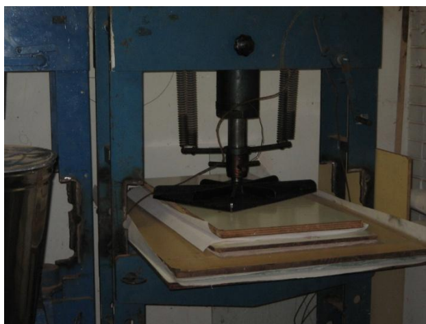
Figura 60. Depois de formadas todas as folhas desejadas leve a pilha de entretelas para uma prensa. Acondicione as entretelas entre duas tábuas forradas com fórmica. Prende para retirar o excesso de água.
