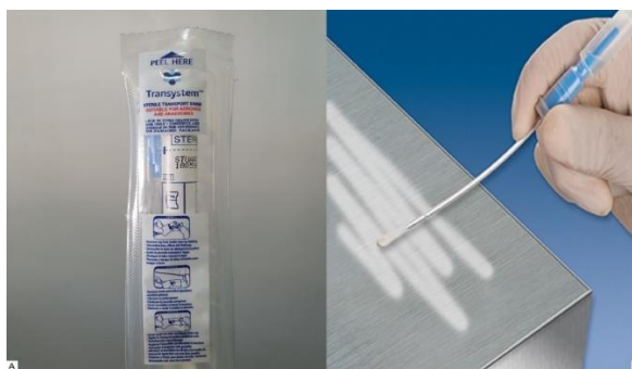
Figura 5 – a) Instrução do fabricante sobre local de abertura indicado pela seta e pela inscrição “ peel here ” na porção superior do swab ; b) Fricção da ponta do swab umedecida sobre a área de coleta
