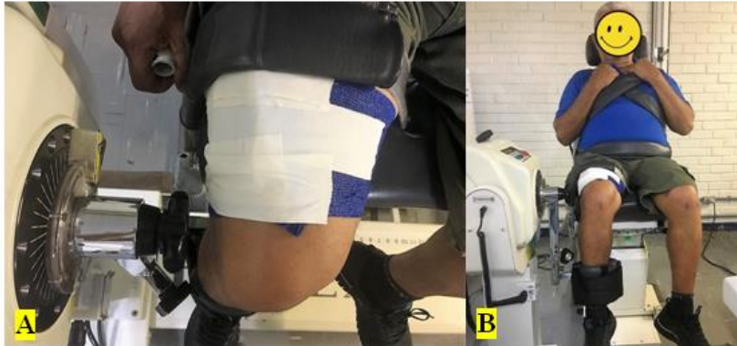
Figura 7. Ilustração do posicionamento do NIRS no músculo vasto lateral direito do paciente e posicionamento no dinamômetro isocinético.
