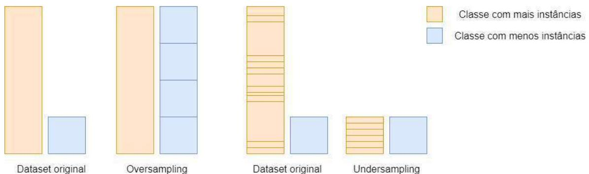
Figura 2.6: Esquematização do processo de *oversampling* e *undersampling*.
