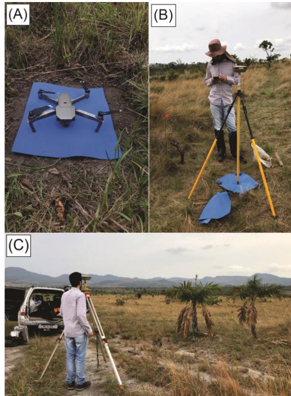
Figura 5.13 – A: Drone DJI Mavic 2 Pro utilizado no levantamento aerofotogramétrico, B e C: Estação total para coleta de pontos processados utilizados para amarração da topografia.
