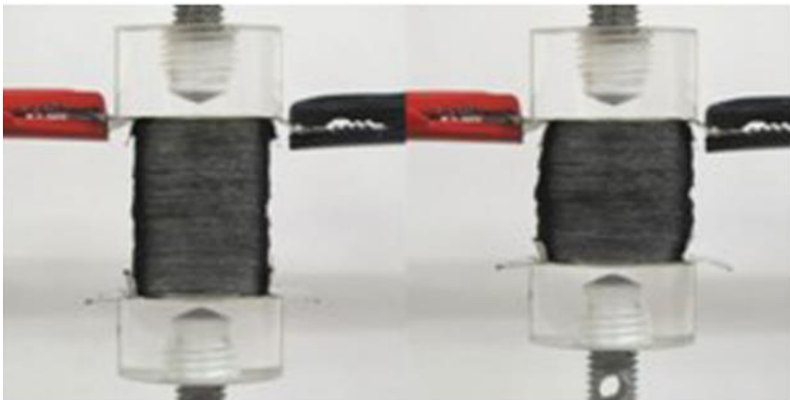
Figura 3 – Exemplo de atuador com elastômero dielétrico multicamadas. Em repouso, esquerda, ativo, à direita.[2] .
