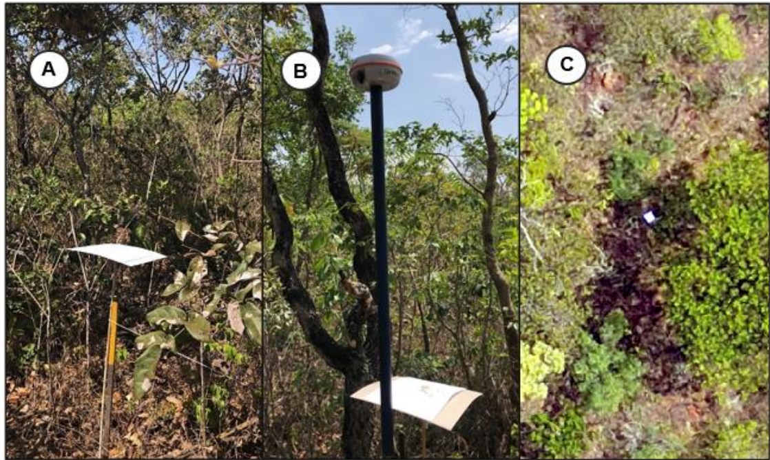
Figura 11. a) Ponto de controle (GCP) no vértice da parcela permanente, confeccionado com cartolina e folha branca. O branco visa garantir uma boa refletância para a identificação na imagem capturada pelo DJI PHANTOM4 Pro; b) DGPS geodésico coletando coordenadas X, Y e altitude Z dos vértices das parcelas permanentes; c) Visualização do alvo no ortomosaico.
