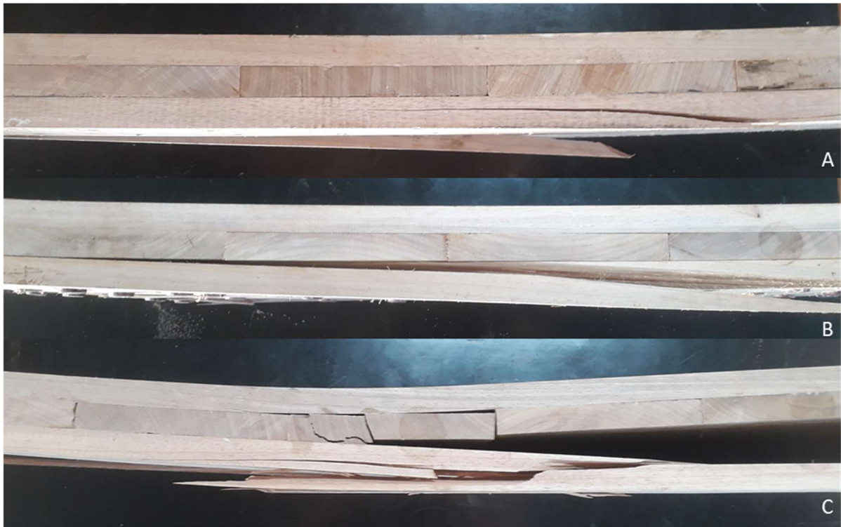
Figura 6. Modos de ruptura dos painéis após o ensaio de flexão: (A) a ruptura de todos os painéis pregados ocorreu após o rompimento das lamelas inferiores; (B) a ruptura dos painéis cavilhados ocorreu majoritariamente após o rompimento das lamelas inferiores; (C) os painéis colados romperam em função do cisalhamento das lamelas intermediárias, ruptura por tração das lamelas inferiores e delaminação da linha de cola.
