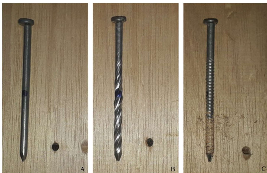
Figura 16. Modos típicos de falha da madeira após arranquio de pregos: (A) o prego liso não causa danos à madeira; (B) o prego espiralado arranca pequenas quantidades de fibras; (C) o prego anelado arranca uma coluna de fragmentos de fibras aderidos a sua haste.
