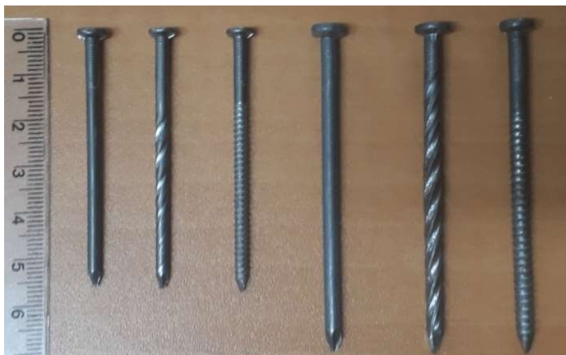
Figura 1. Pregos utilizados nos ensaios: liso 16 x 24, espiralado 16 x 24, anelado 16 x 24, liso 18 x 30, espiralado 18 x 30 e anelado 18 x 30.
