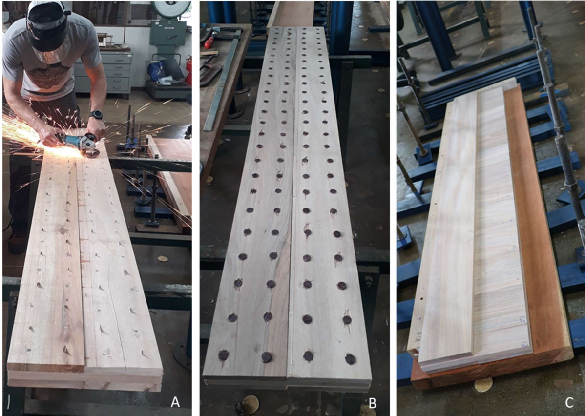
Figura 2. (A) Eliminação das pontas dos pregos no painel de madeira lamelada cruzada pregada. (B) Painel de madeira lamelada cruzada cavilhada. (C) Montagem das lamelas sobre a prensa para a confecção do painel de madeira lamelada cruzada colada.
