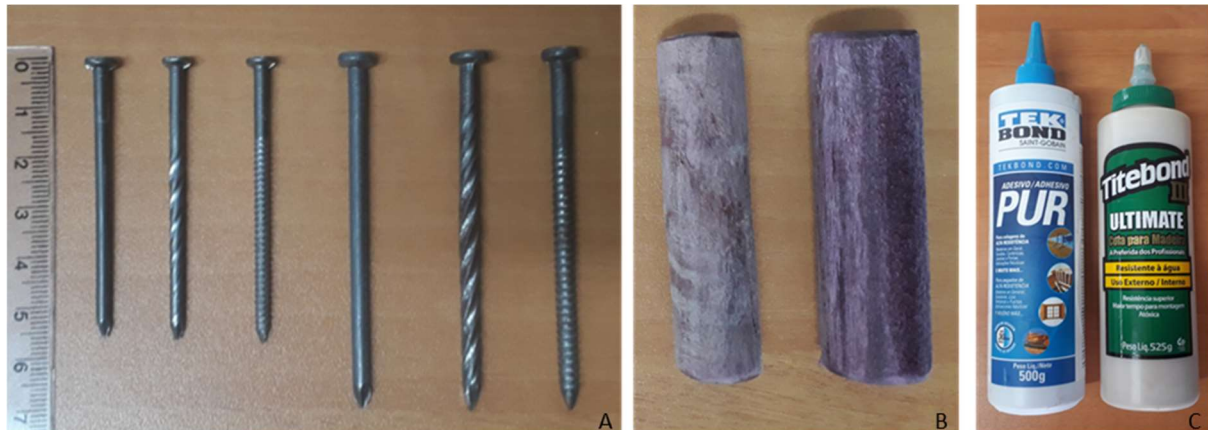
Figura 2. (A) Pregos lisos, espiralados e anelados nas medidas 16 x 24 e 18 x 30. (B) Cavilhas de roxinho de 16 e 20 mm. (C) Adesivos PUR e PVAc.
