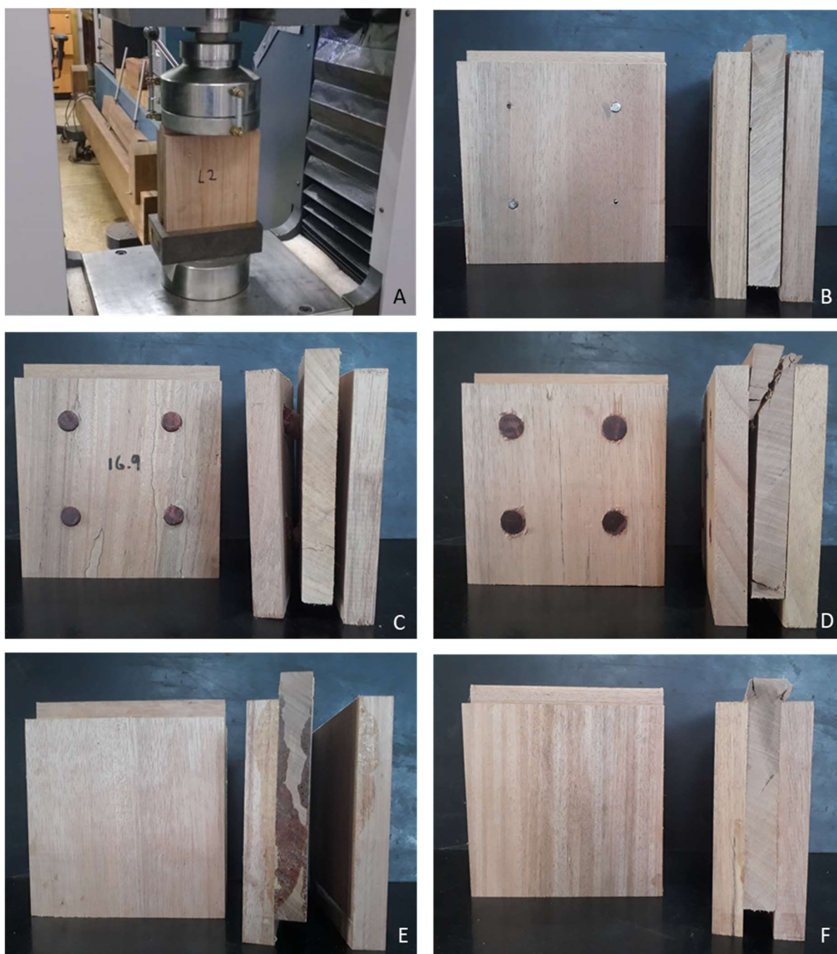
Figura 3. (A) Máquina universal de ensaios executando ensaio de compressão dos corpos de prova em duplo corte. (B) Plastificação dos pregos sem esmagamento ou ruptura da lamela central. (C) Plastificação e ruptura das cavilhas de 16 mm. (D) Esmagamento e ruptura da lamela central dos corpos de prova conectados por cavilhas de 20 mm. (E) Cisalhamento na linha de cola dos corpos de prova confeccionados com PUR com baixo percentual de falha na madeira. (F) Esmagamento da lamela central sem ocorrência de cisalhamento da linha de cola dos corpos de prova confeccionados com PVAc.
