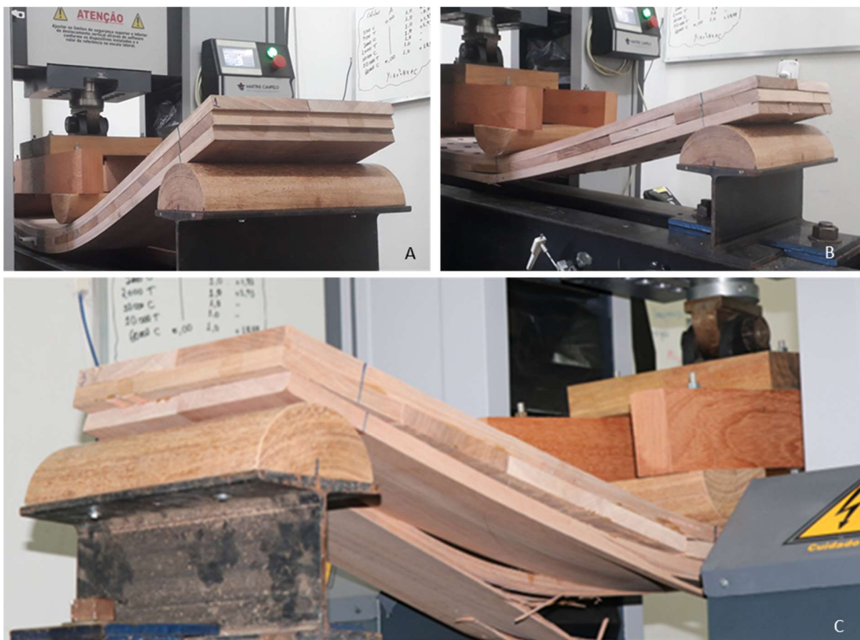
Figura 5. Comportamento dos painéis ao longo dos ensaios: (A) painel de NCLT apresentando as maiores flechas e formação de “degraus” em função do cisalhamento entre as lamelas; (B) painel de DCLT apresentando abertura de frestas entre as lamelas e rompimento da lamela inferior seguindo o padrão do posicionamento das cavilhas; (C) Painel de CLT apresentando cisalhamento das lamelas intermediárias, rompimento das lamelas inferiores e delaminação da linha de cola.
