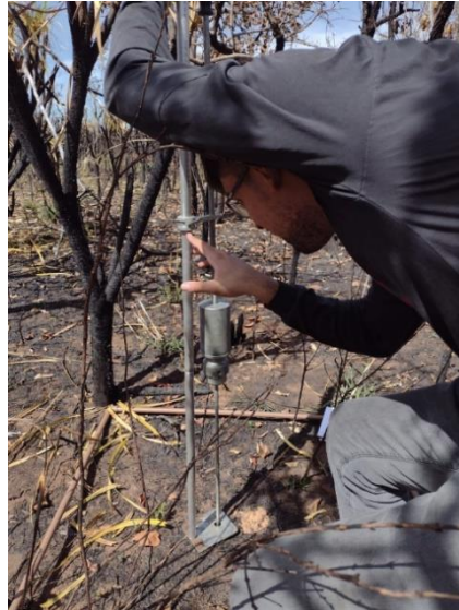
Figura 5 – Penetrômetro de impacto Stolf
