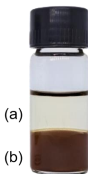
Figura 14. Nanopartículas funcionalizadas com bicamada de AL em meio aquoso (fase b). Fase (a) hexano.
