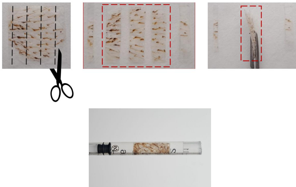
Figura 28. Preparação da amostra para as medidas de ressonância ferromagnética. A seção da pele utilizada está destacada em vermelho. Ilustração da autora.
