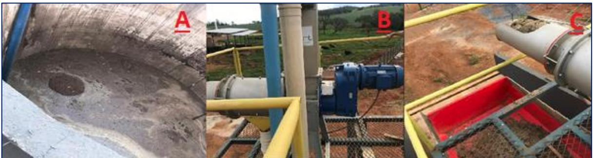
Figura 8. Pré-tratamento da matéria prima. A: Tanque de homogeneização; B: motor separador; e C: composto sólido usado como cama animal.
