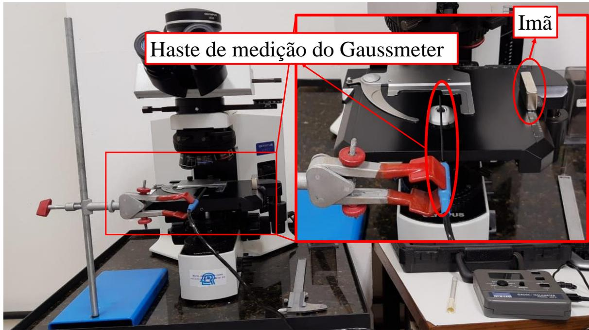
Figura 4.14 – Foto da configuração experimental para se medir a intensidade de campo magnético gerado por um imã permanente de acordo com uma distância perpendicular horizontal da posição em que se colocaria a amostra de emulsão.
