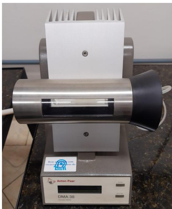
Figura 4.8 – *Densímetro Anton Paar modelo DMA38 pertencente ao Laboratório de Microhidrodinâmica e Reologia - MicroReo - VORTEX - Universidade de Brasília..*
