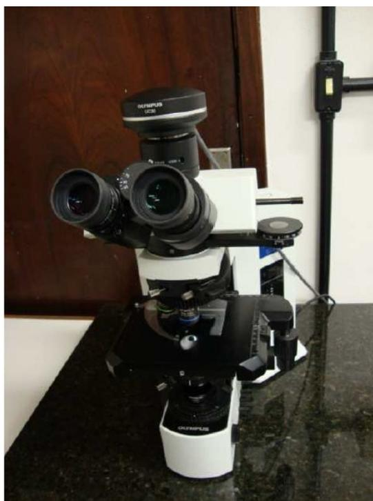
Figura 4.7 – *Microscópio Olympus BX51 com câmera UC30 e ampliação ocular é 10X. As lentes disponíveis têm ampliação de 2X, 5X, 10X, 20X e 50X.*
