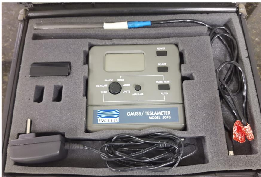
Figura 4.13 – Gaussmeter utilizado para coletar dados de campo magnético. Modelo 5070.
