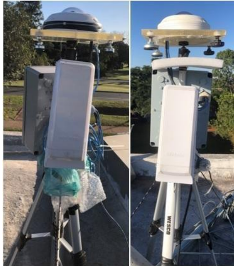
Figura 38: Antenas direcionais instaladas no tripé sob as câmeras. Do lado esquerdo antena instalada no tripé da câmera 1 e do lado direito, na câmera 2.
