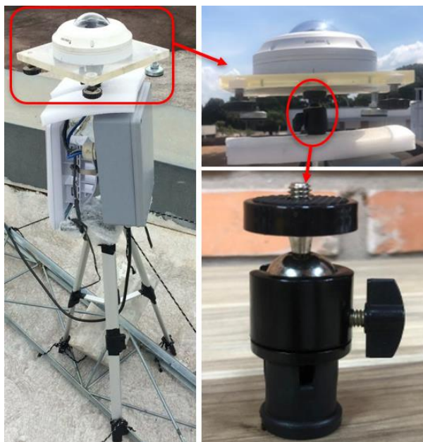
Figura 37: Sistema de alinhamento e nivelamento das câmeras. Fonte: Elaborado pelo autor.
