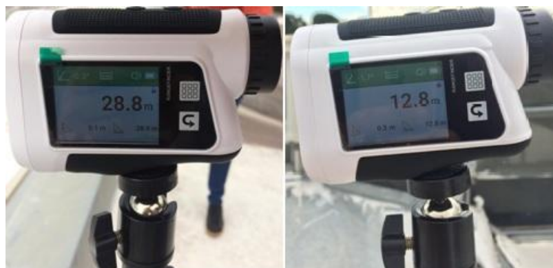
Figura 41: Aferição da medida do espaçamento das câmeras. Fonte: Elaborado pelo autor.
