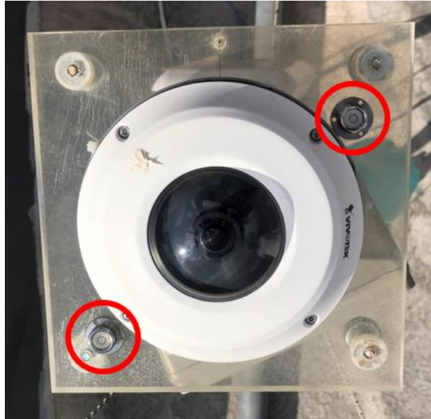
Figura 42: Nivelamento das câmeras. Fonte: Elaborado pelo autor.
