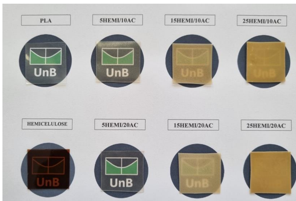
Figura 19 – Aparência visual dos filmes de hemicelulose e PLA puros em comparação às blendas.
