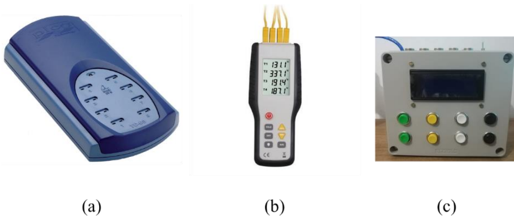
Figura 3.31 – Sistemas de aquisição de dados utilizados nesta tese, (a) PICO – 08, (b) HT 9815 e (c) Datalogger 10 canais em plataforma Arduino.
