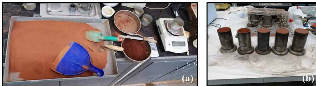
Figura 3.7 – (a) Solo coletado seco em estufa e destorroado para moldagem. (b) Moldes de amostras em corpos de prova de dimensões 5x10cm nas cinco massas específicas aparente secas.
