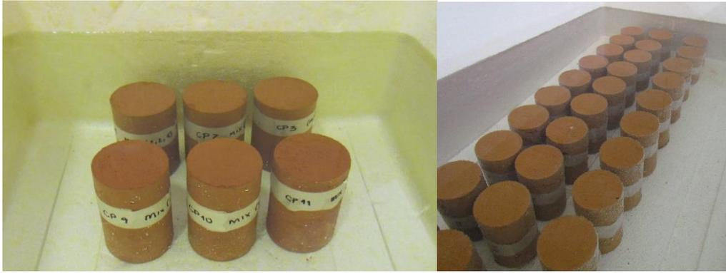
Figura 3.15: Segunda fase do processo de cura: corpos de prova imersos na água.
