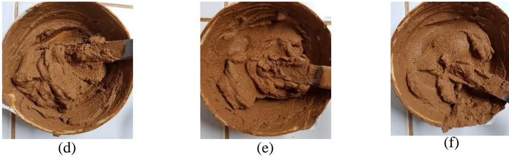
Figura 3.11: Fases da preparação da amostra de solo-cimento, ensaio de limite de liquidez pelo método do cone: (a) Solo (1, 2 e 3 m), cimento e água; (b) Momento inicial da mistura; (c) Após 2 min. de homogeneização; (d) Após 5 min. de homogeneização; (e) Após 10 min. de homogeneização; (f) Após 15 min. de homogeneização.
