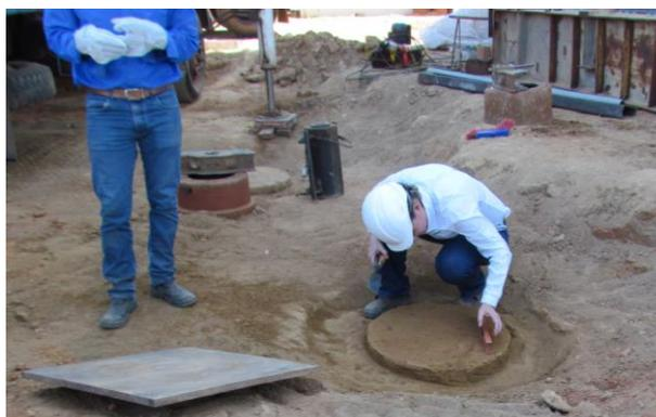
Figura 3.24: Nivelamento da estaca e retirada do solo de entorno nos primeiros 5 cm da estaca, permitindo a placa ser assente somente sobre a estaca DMM.
