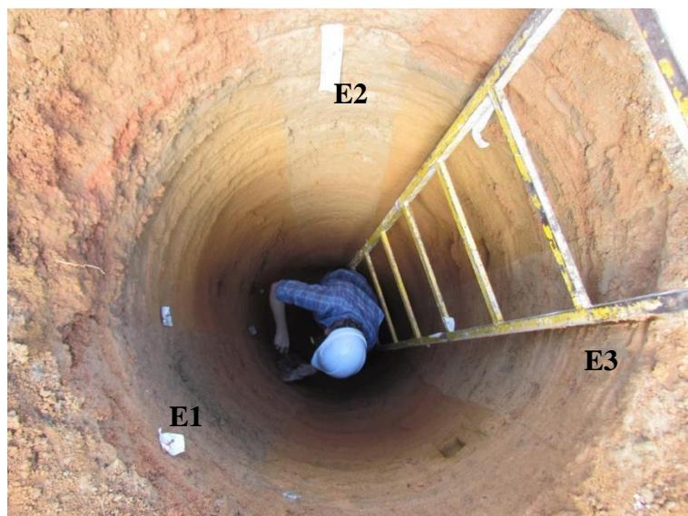
Figura 4.50: Exumação das estacas E1, E2 e E3.
