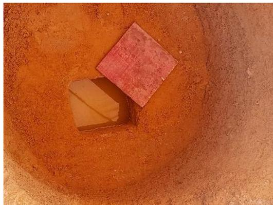
Figura 3.8: Ensaio de infiltração em cava na profundidade de 1 m.
