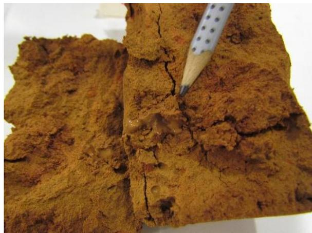
Figura 4.53: “Grumo líquido” no interior do corpo de prova moldado a partir da amostra indeformada do material da E2.
