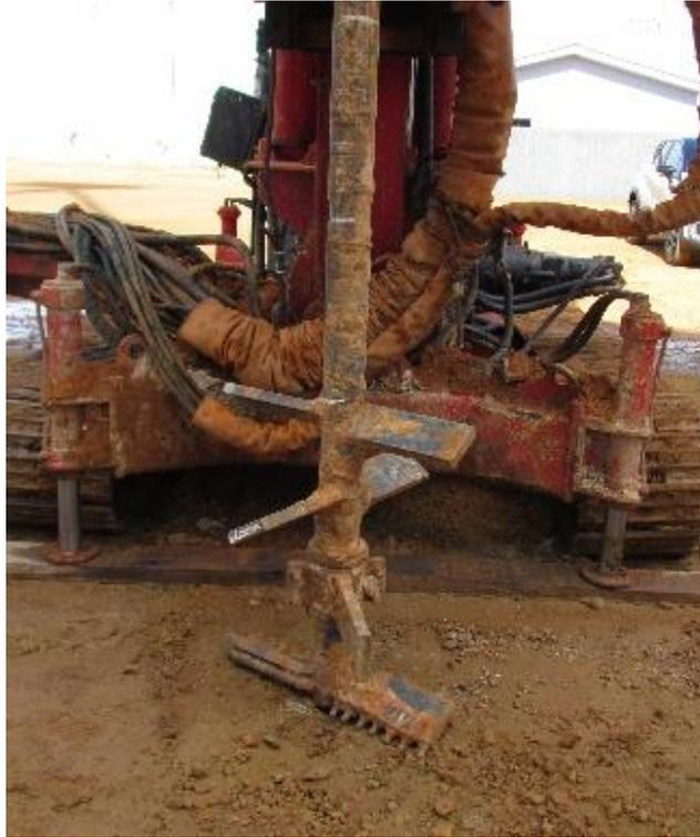
Figura 3.16: Trado confeccionado para execução de estacas DMM.
