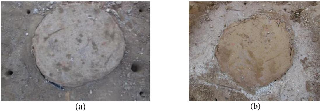
Figura 4.57: Topo da estaca E11 após execução das provas de carga: (a) topo da estaca após a execução da prova de carga em 2019; (b) topo da estaca após a execução da prova de carga em 2020.
