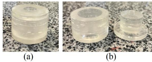
Figura 26: (a) Dispositivo confeccionado para remoção das amostras; (b) Dispositivo desmontado.
