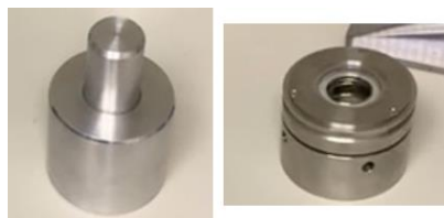
Figura 16: Molde de aço desenvolvido para realização do ensaio de FRX.
