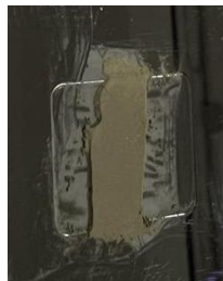
Figura 20: Método 2 - parte traseira da lâmina reflexiva com preenchimento do cimento em filete.
