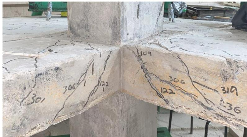
Figura 4.9: Reentrância da Laje S14 após colapso
