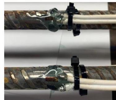
d) Proteção de resina à base epóxi (*Araldite*)
