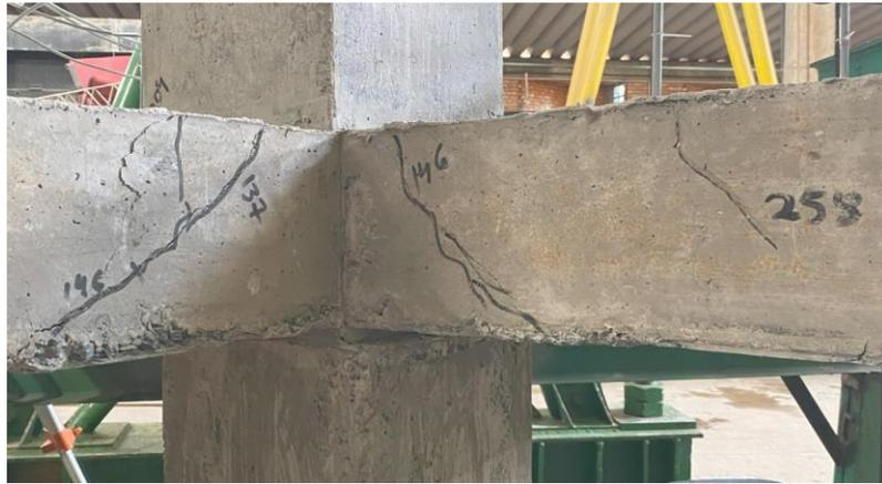
Figura 4.8: Reentrância da Laje S13 após colapso
