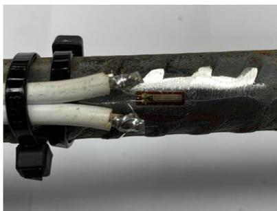
c) Extensômetro fixado com *Super Bonder* e Soldado no cabo
