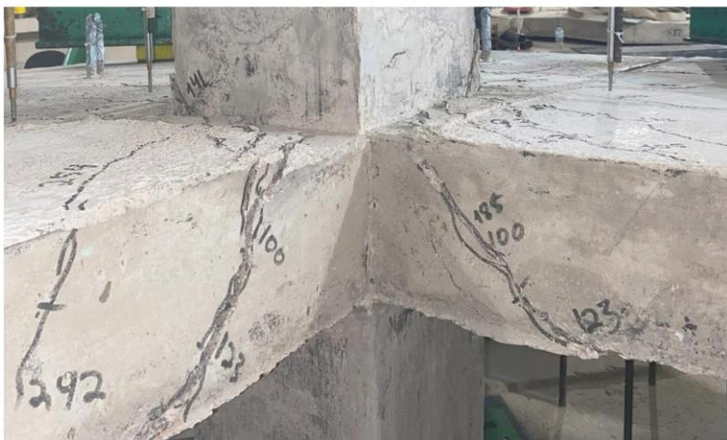
Figura 4.10: Reentrância da Laje S15 após colapso
