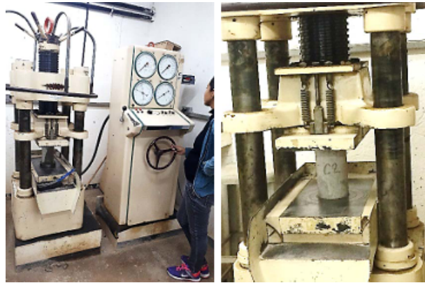
Figura 30 – Ensaio de resistência à compressão do concreto Silva (2018).
