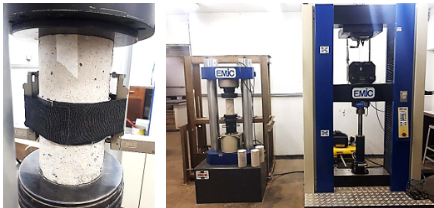
Figura 31 – Ensaio de módulo de elasticidade do concreto Silva (2018).
