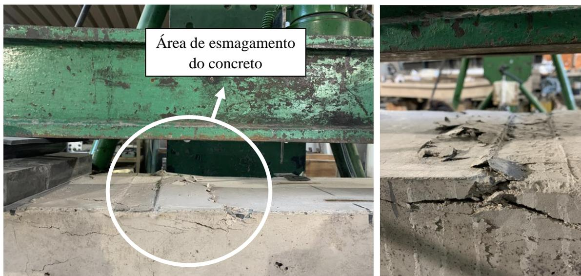
Figura 4.76: Seção de esmagamento do concreto na viga VA10
