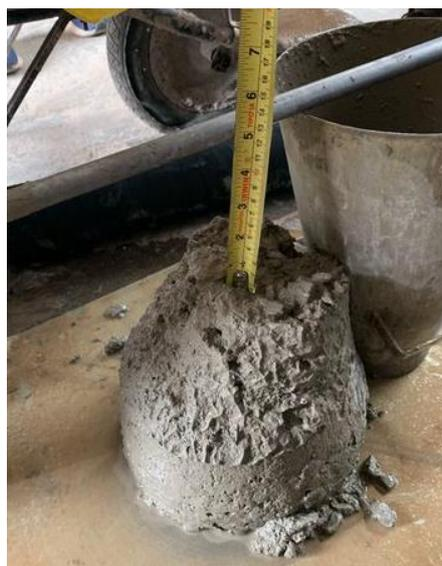
Figura 3.13: Amostra de concreto submetida ao ensaio de abatimento do tronco de cone
