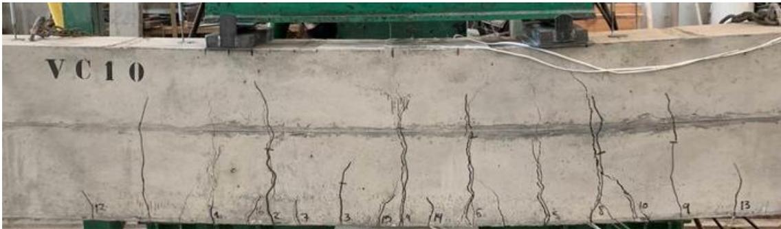
Figura 4.4: Vista frontal do trecho central da viga VC10 após o ensaio
