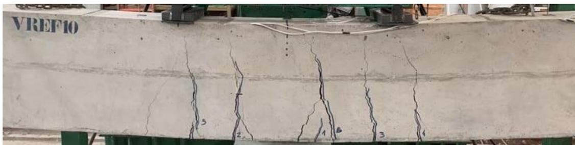
Figura 4.1: Vista frontal do trecho central da viga VREF10 após o ensaio
