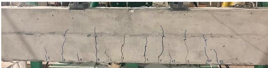
Figura 4.2: Vista frontal do trecho central da viga VREF16 após o ensaio
