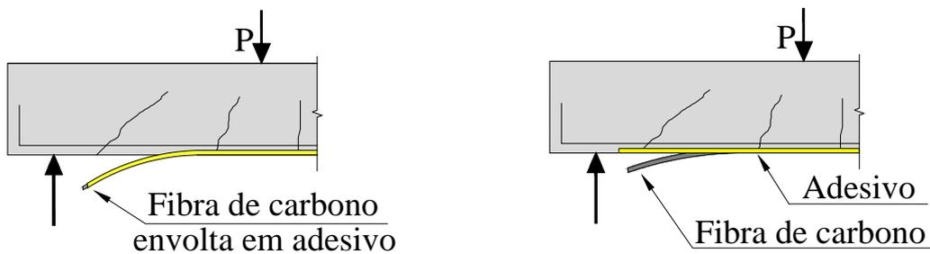
Figura 2.11: Ruptura dada pelo descolamento do PRF (DE)
