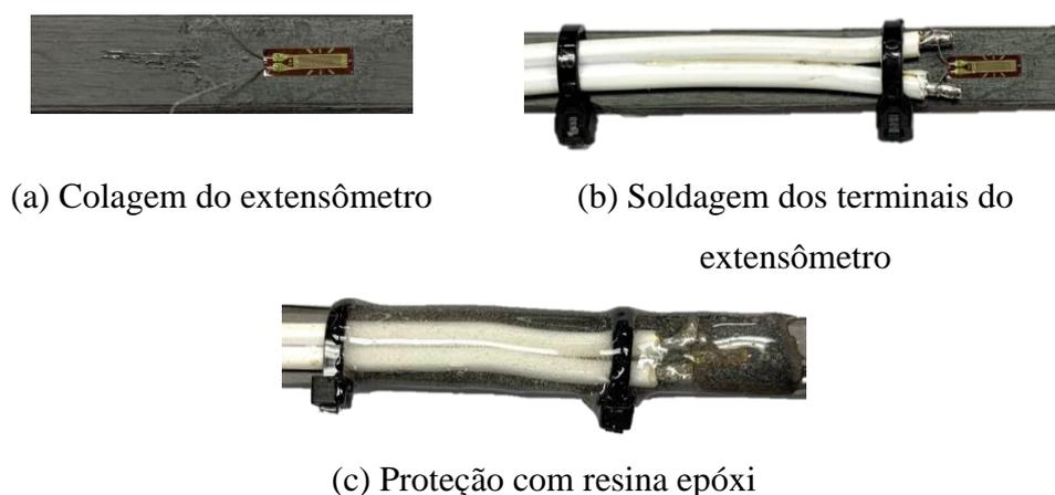
Figura 3.21: Posicionamento dos extensômetros no laminado de PRFC
