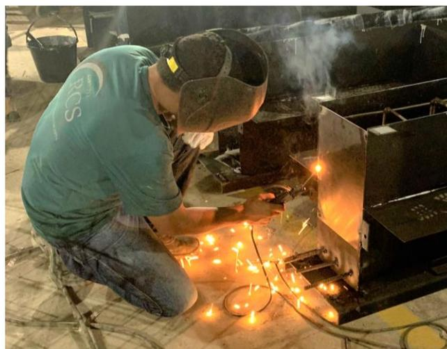
Figura 3.10: Processo de soldagem das chapas metálicas de ancoragem mecânica
