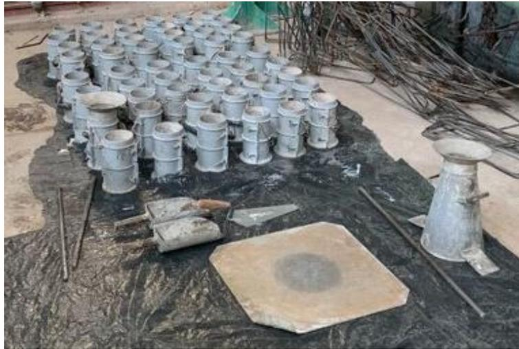
Figura 3.12: Fôrmas de corpos de prova de concreto e materiais utilizados para o teste de abatimento de cone
