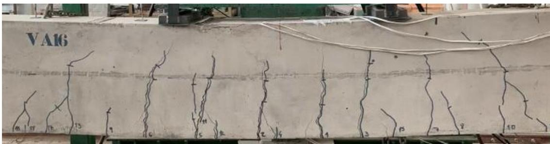
Figura 4.8: Vista frontal do trecho central da viga VA16 após o ensaio
