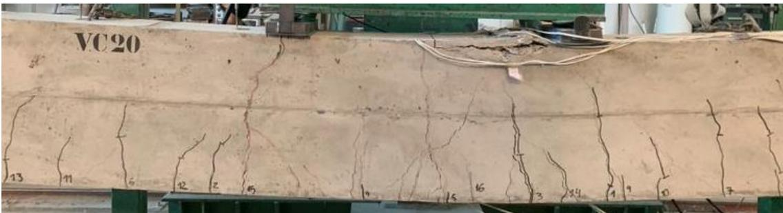
Figura 4.6: Vista frontal do trecho central da viga VC20 após o ensaio
