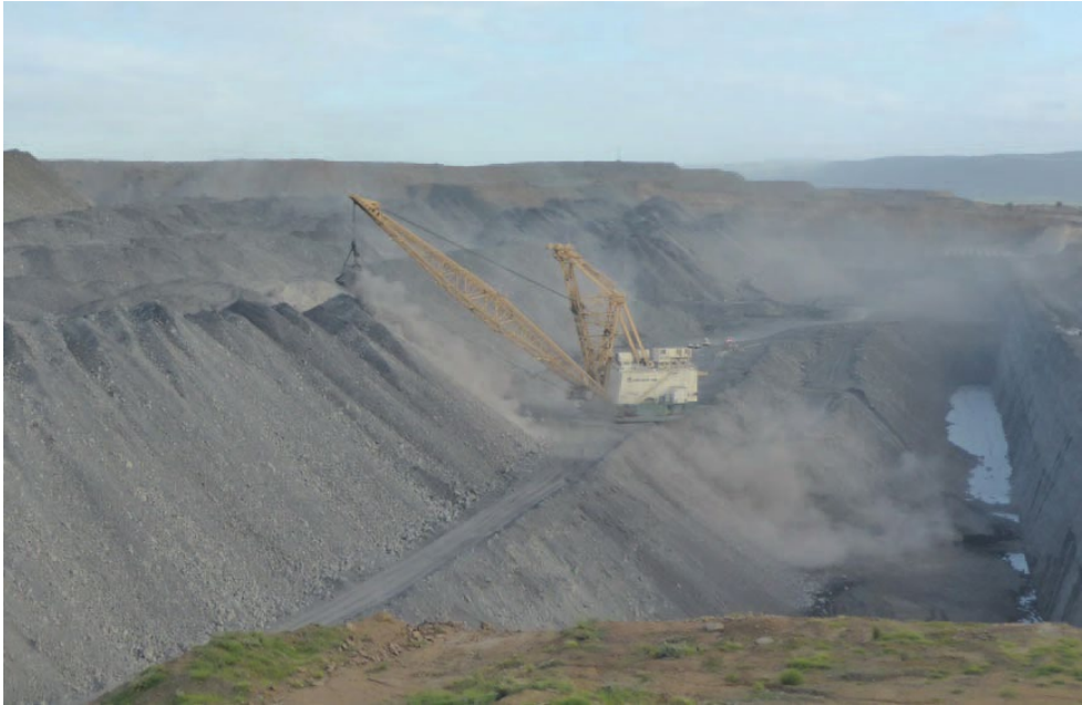
Figura 2.20 - Operação típica de dragline na cava, mostrando as características do perfil de inclinação da pilha de estéril ou pilha de spoil (Simmons & Yarkosky, 2017).
