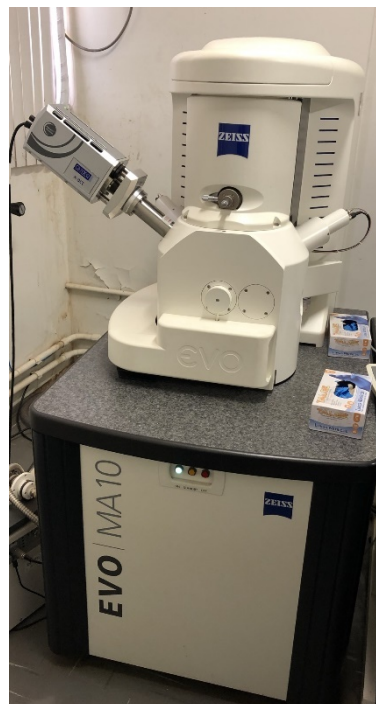
Figura 3.5 – Caracterização microestrutural com uso de microscópio eletrônico de varredura.
