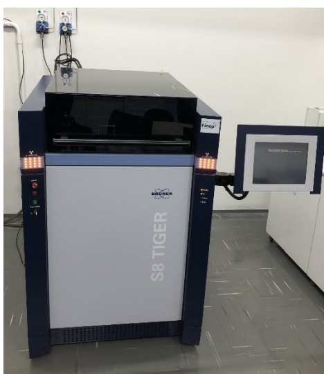
Figura 3.7 - Análises químicas por Espectrometria de Fluorescência de Raios-X.
