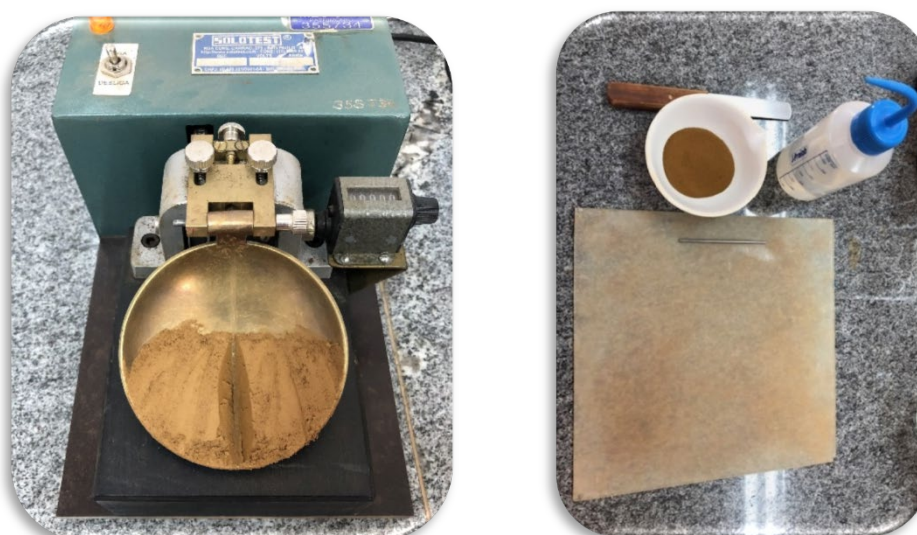
Figura 3.3 - Ensaio de limites de consistência: a) limite de liquidez; b) limite de plasticidade.
