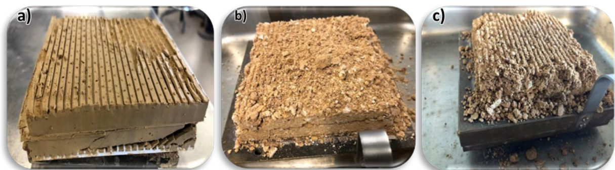
Figura 4.67 – Amostras cisalhadas de resíduos de fosfato: a) Slime ; b) Shale ; c) Mistura 1,1:1.
