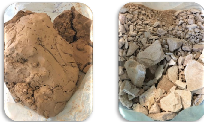
Figura 3.19 – Amostras de resíduos de fosfato: a) Slimes ; b) Shale .
