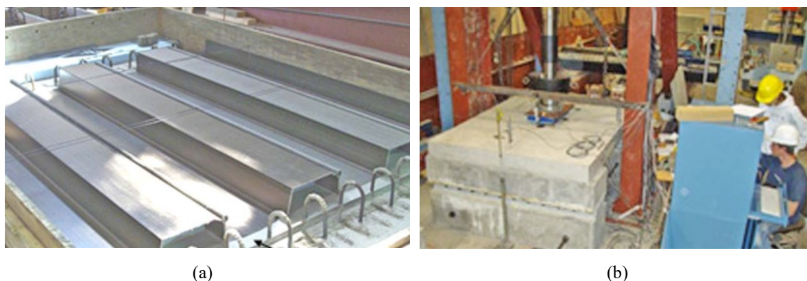
Figura 11 - Modelo estudado por Fam e Nelson (2012). (a) Configuração geométrica; (b) Setup do ensaio.
