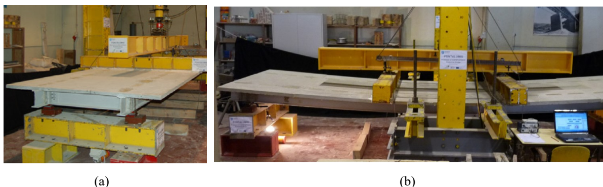
Figura 14 - Estudo realizado por Gonilha, Correia e Branco (2014): (a) Vista frontal (b) Deformação antes da ruptura.
