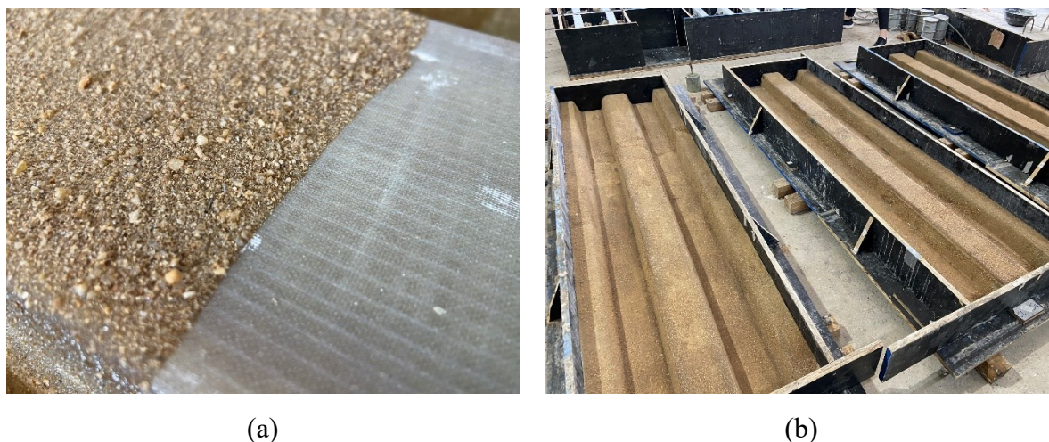
Figura 43 - Tratamento na superfície do compósito e fôrma utilizada. (a) diferença entre superfície normal \times tratada; (b) fôrmas executadas;
