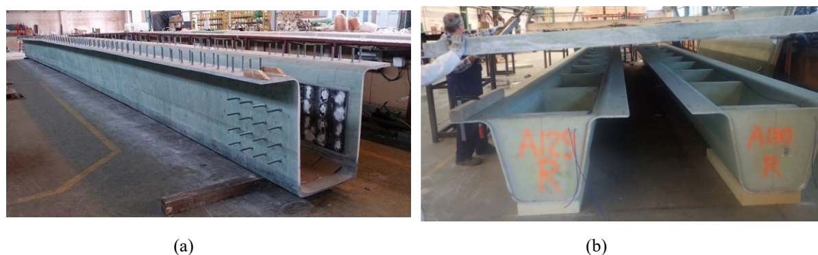
Figura 17 – Vigas compósitas de PRFV em formato trapezoidal. (a) Trabalho inicial de Siwowski e Rajchel, (2019); (b) Continuação da pesquisa por Siwowski, Rajchel e Wlasak (2021).
