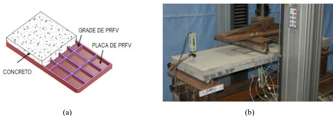
Figura 15 - Modelo de laje proposta por Fang et al. , (2016): (a) Design proposto; (b) Setup do ensaio
