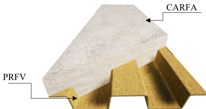
Figura 2 - Esquema representativo da laje mista proposta, composta por fôrma permanente de PRFV e CARFA.
