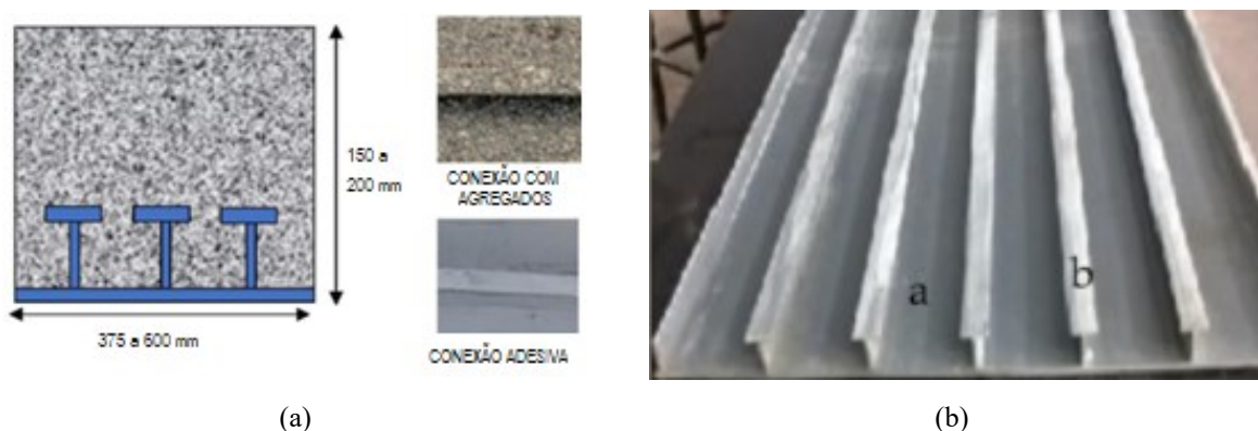
Figura 19 - Laje investigada por Goyal et al. , (2022) (a) modelo da seção transversal; (b) fôrma de PRFV utilizada.
