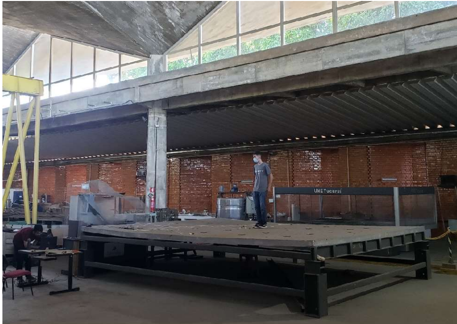
Figura 3-3: Teste de vibração de impulso e laje monitorada.
