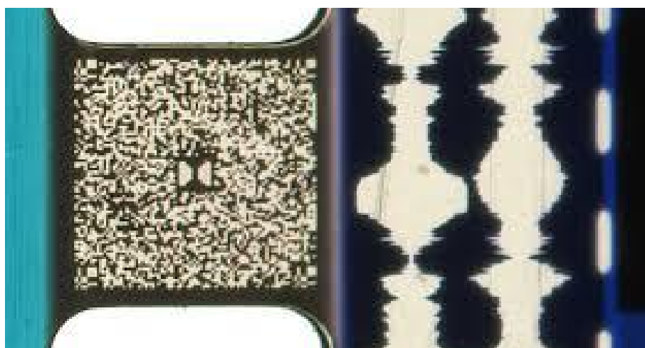
Figura 17 - Fotografia de uma película perfurada
