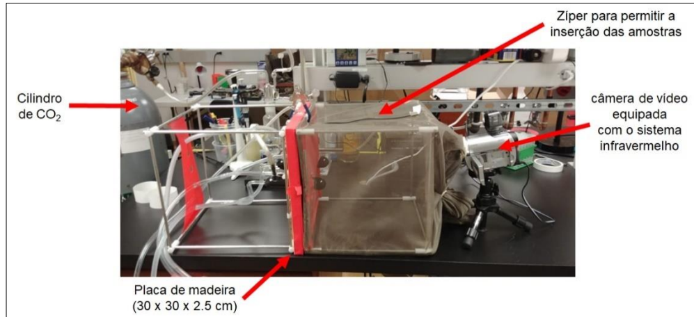
Figura 17. Aparato para realização do surface landing and feeding assay . Em detalhe, câmera de vídeo equipada com sistema infravermelho.
