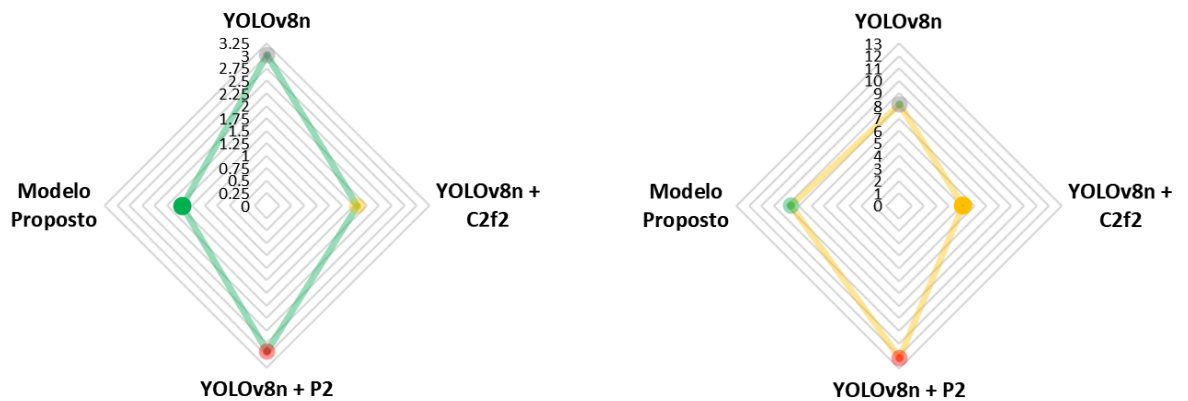
Figura 4.7 – Resultados obtidos para número de parâmetros, em milhões, e para número de operações de ponto flutuante por segundo, em FLOPS(G) para o experimento de ablação sobre YOLOv8. A cor predominante representa o modelo ablacionado vencedor em cada medida.
