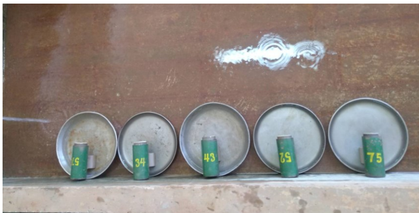
Figura 4.6. Amostras compactadas em cilindro Mini-MCV submetidas à perda de massa por imersão em tanque com água.
