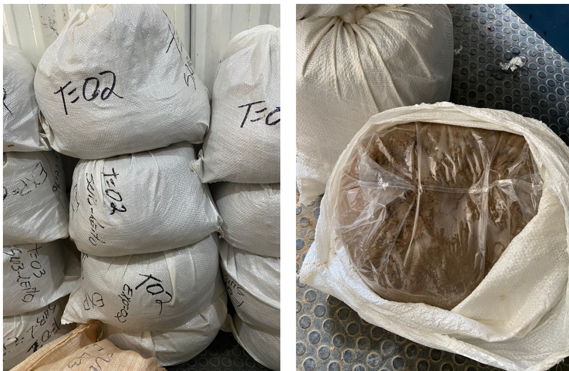
Figura 4.2. a) Sacos com aproximadamente 30 kg de material das camadas dos SE. b) Amostras embaladas com dupla proteção para evitar perda de material.
