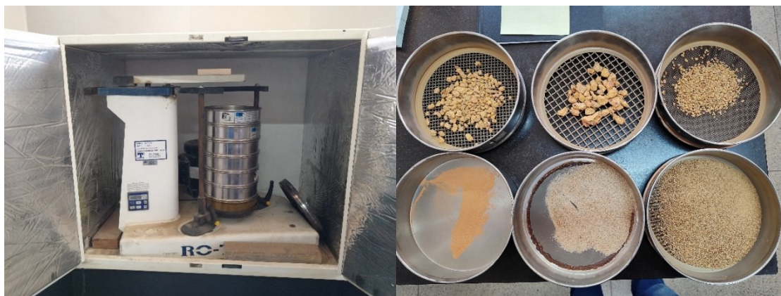
Figura 4.4. Agitador mecânico empregado no peneiramento das amostras de solos e material britado – à esquerda. Peneiras de diferentes aberturas com amostras de solo - à direita.
