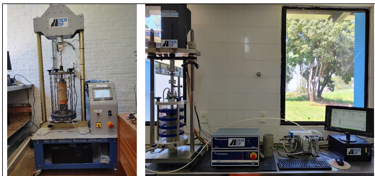
Figura 4.7. Triaxiais dinâmicos empregados na obtenção de dados de MR e DP.
