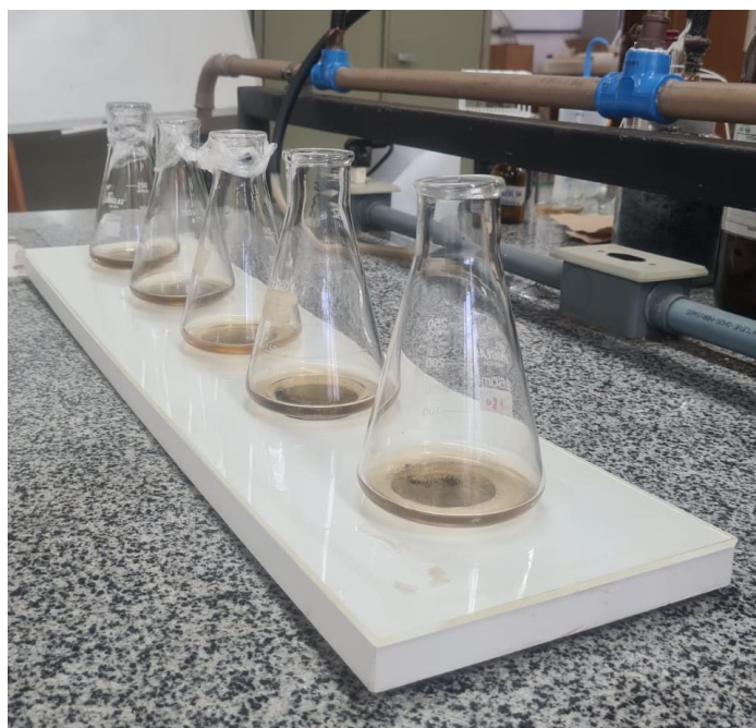
Figura 4.8 - Etapa de separação das nanopartículas após os ensaios de adsorção com aplicação de campo magnético com ímã convencional do LSA/UnB.
