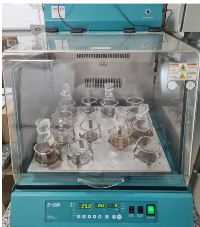
Figura 4.7 - Realização de ensaio em agitador horizontal modelo SI 600R (GMI) com controle de temperatura a 25 °C no Laboratório de Saneamento Ambiental (LSA/UnB)
