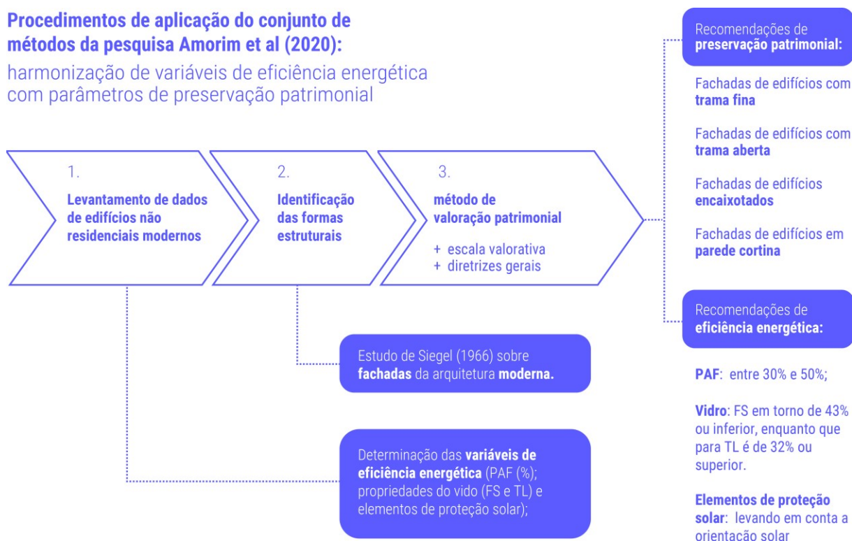
Figura 47 Esquema da base procedimental do conjunto de métodos da pesquisa Amorim et al. (2020) Fonte: Autora
