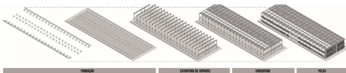
Figura 24. isométricas da montagem do ed. administrativo do CAIC José Jofilly Fonte: PEREIRA, 2000.
