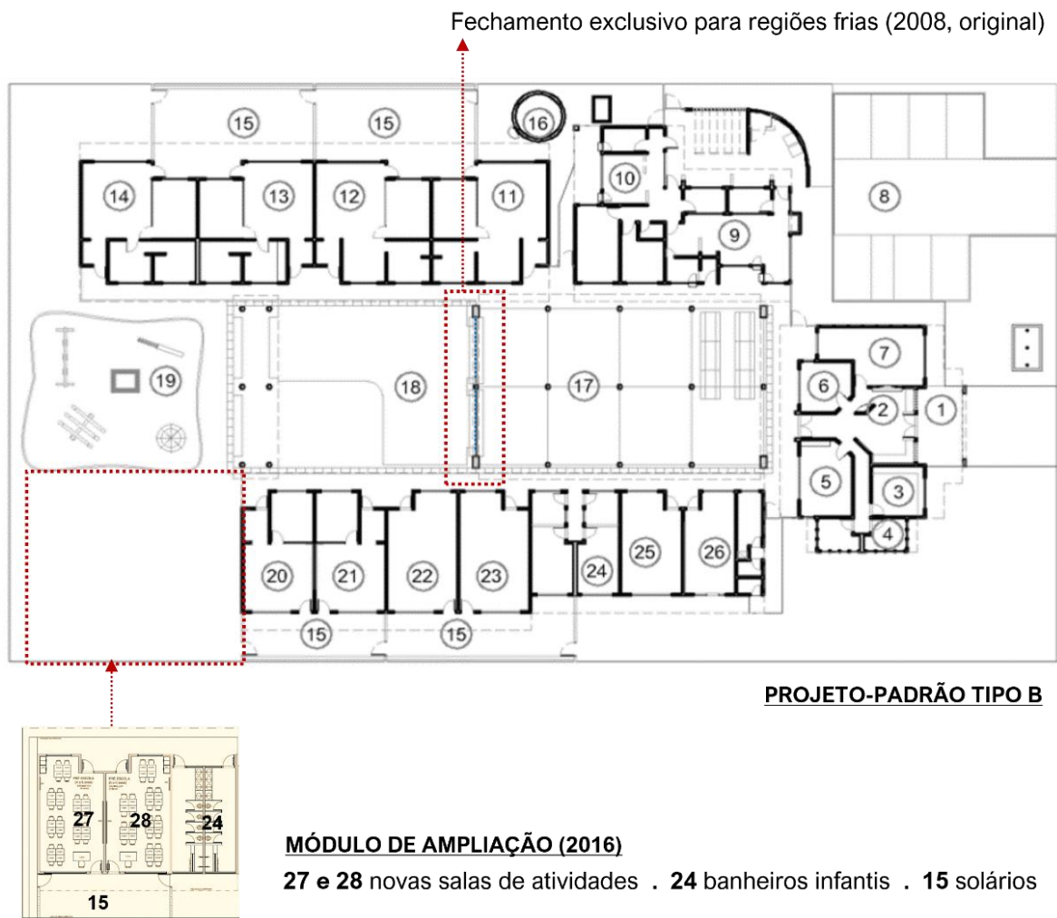
Figura 42. planta baixa – Proinfância tipo B, com módulo de ampliação Fonte: FNDE, 2016, adaptada pela autora.
