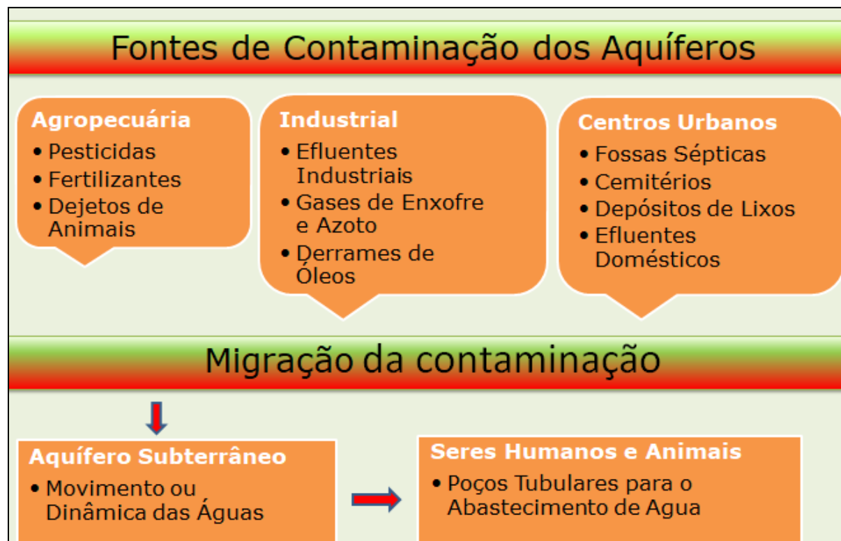
Figura 02: Fluxograma demonstrativo das diferentes fontes de contaminação e o respectivo processo de migração da contaminação.
