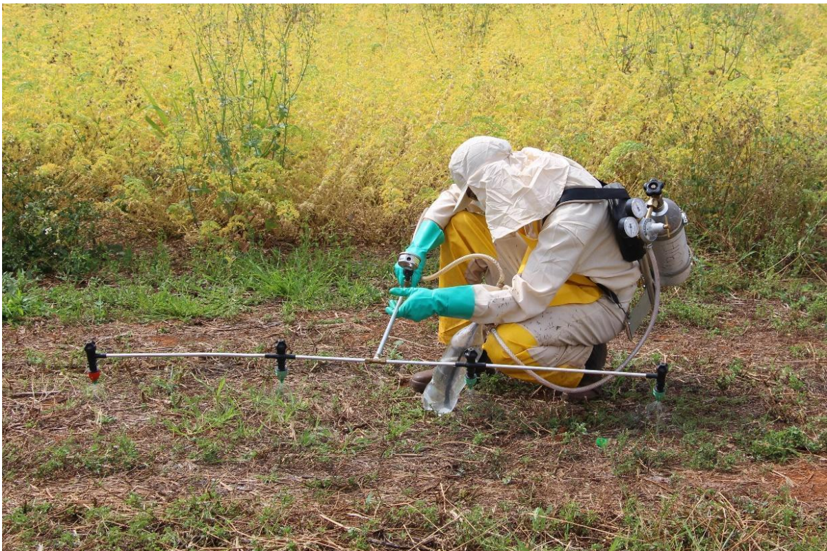
Figura 4 – Operador testando sistema de pulverização costal pressurizado por CO 2 . Fazenda Sucupira, 2018.
