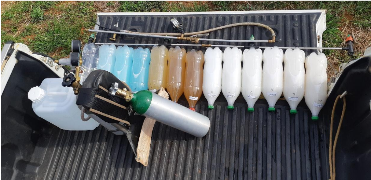
Figura 3 – Barra do pulverizador, garrafas contendo os tratamentos (herbicida e dose) e pulverizador costal com cilindro de CO 2 . Fazenda Sucupira, 2018.
