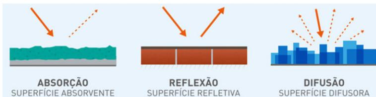
**Figura A- 8: Absorção, reflexão e difusão**
