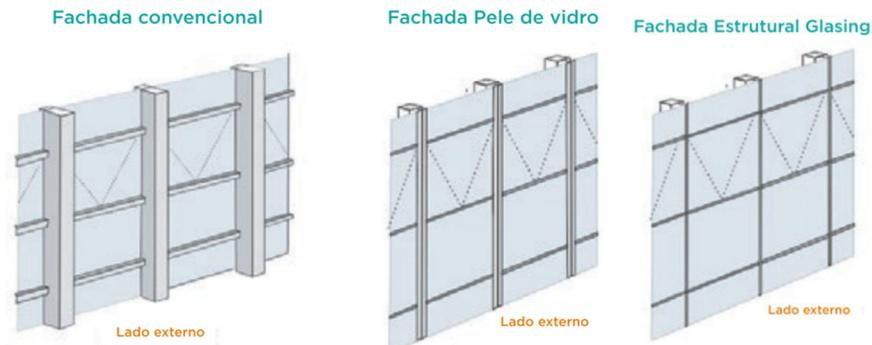
**Figura A- 40: Sistemas de fachadas cortinas**
