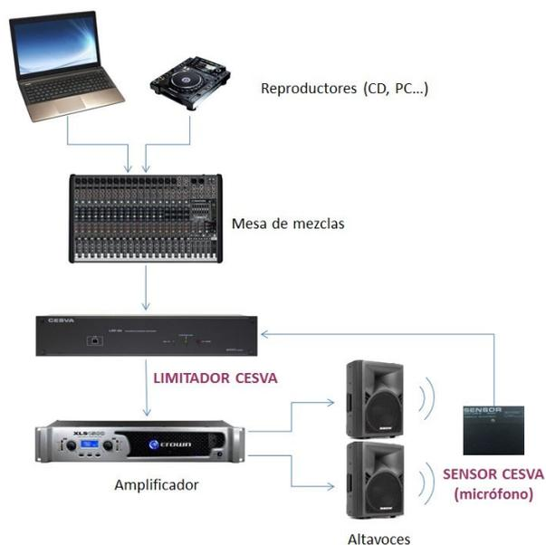
**Figura A- 51: Esquema de funcionamento de um limitador acústico**
