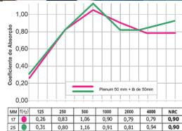
**Figura A- 61: Pannel de parede absorvedor Fiberwood Mosaico, da Sonex**
