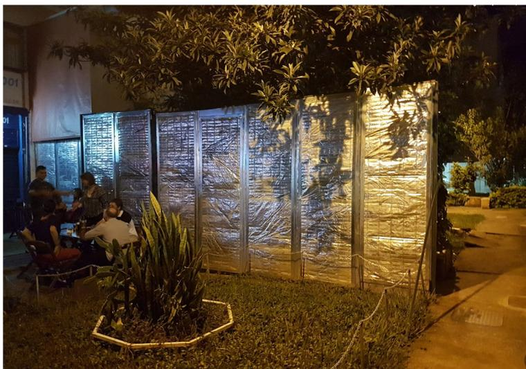
**Figura A- 25: Barreira acústica móvel de um bar na Asa Norte, com superfície refletora**
