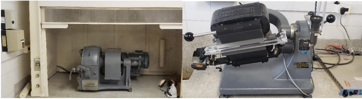
Figura 19: A esquerda: Moinho de disco; A direita: Separador magnético isodinâmico Frantz, tipo barreira magnética. Retirado de www.legga.unb.br
