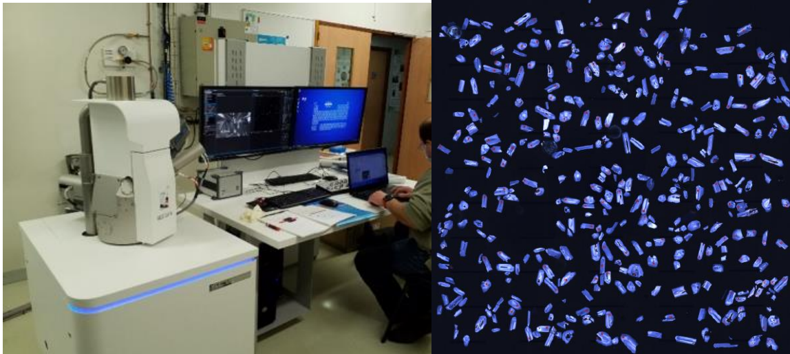
Figura 21: MEV Tescan Vega 4 LMU localizado no GET – Toulouse (Retirado de www.get.omp.eu ) e imagem panorâmica da amostra M2AR 1-3.
