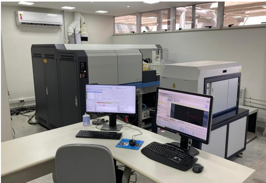
Figura 22: Neptune XT TM MC-ICP-MS localizado no LEGGA-UnB - Brasília (Retirado de www.legga.unb.br )
