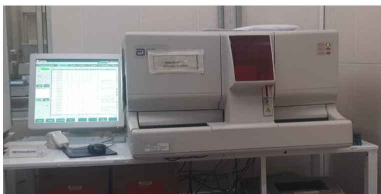
Figura 3.2. Aparelho CELL-DYN Ruby utilizado para realização de exames hemetológicos no Hospital Regional de Santa Maria, Brasília-DF, Brasil. Fonte: Próprio autor.
