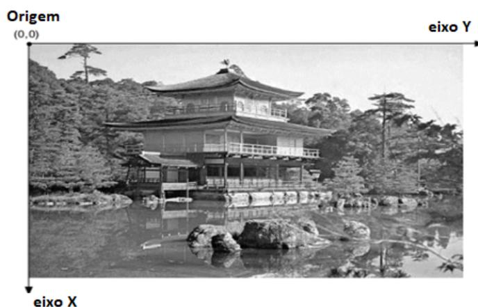
**Figura 2.6.** Imagem digital monocromática representada nas coordenadas X e Y. Adaptado de: (Filho e Neto, 1999).
