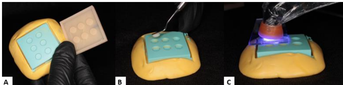
Figura 5 - Confeção dos espécimes em disco para resina composta. 5.A: Gabarito em positivo impresso e molde em silicone em negativo. 5.B: adaptação do espécime com a resina composta Z100. 5.C: Fotopolimerização.
