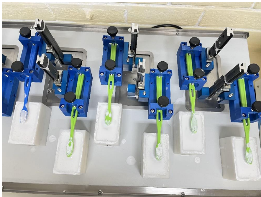
Figura 8 - Espécimes adaptados para resistência a escovação
