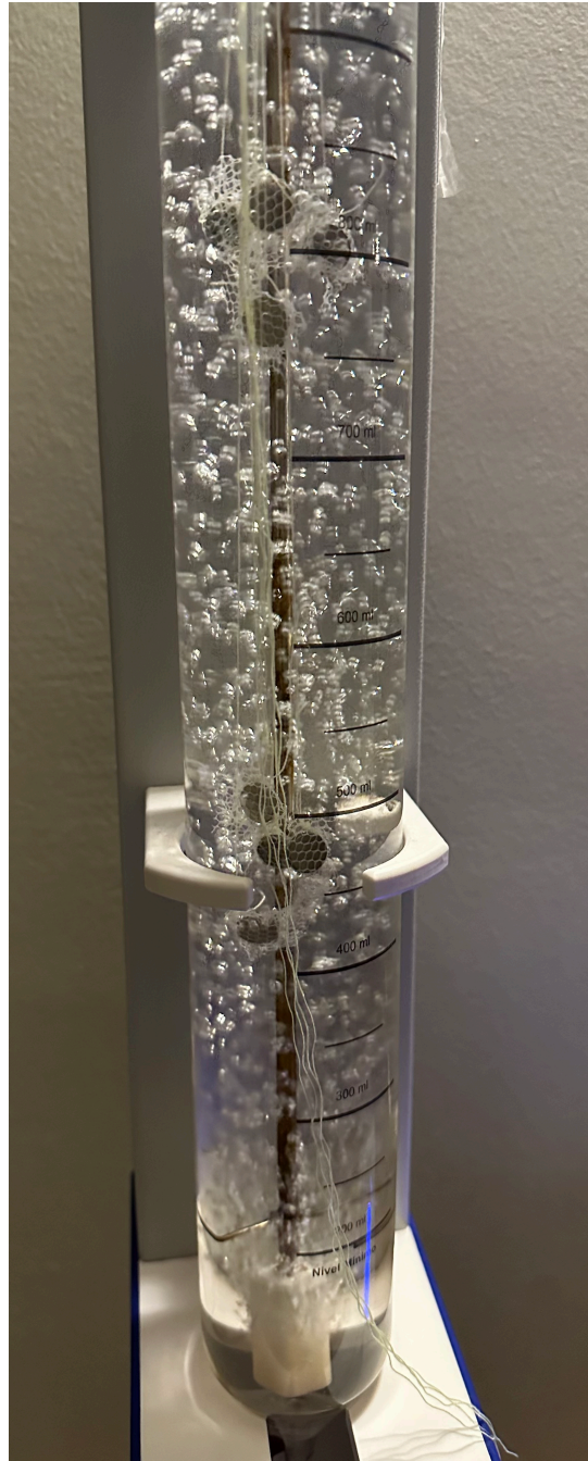
Figura 1 – Discos de titânio submersos em água bidestilada em processo de ozonização contínuo
